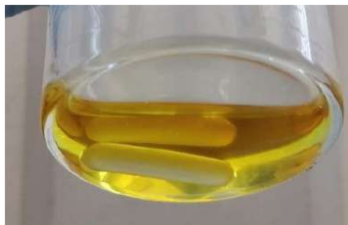
Figura 21. Prueba de solubilidad de la celulosa microcristalina en medio de H_2SO_4 al 37% al principio de la agitación
