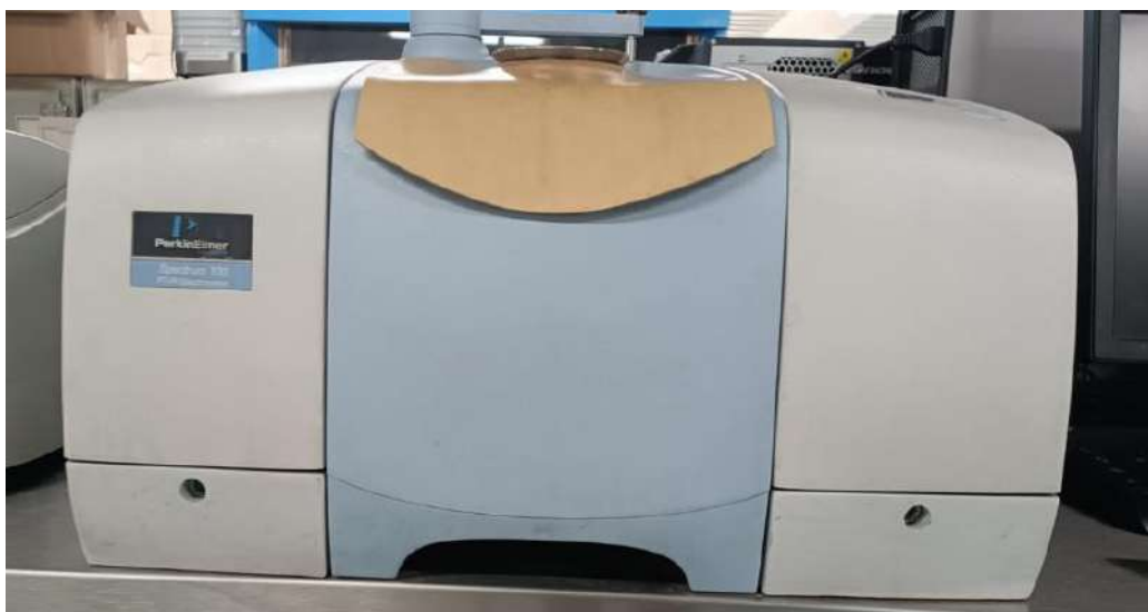
Figura 12 Espectrofotómetro FT-IR empleado para determinar la estructura
