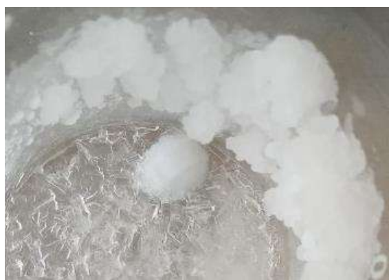
Figura 17. Solidificación del LI 3 p-toluensulfonato de colina con sulfato de magnesio anhidro después de dejarlos en contacto durante toda la noche.
