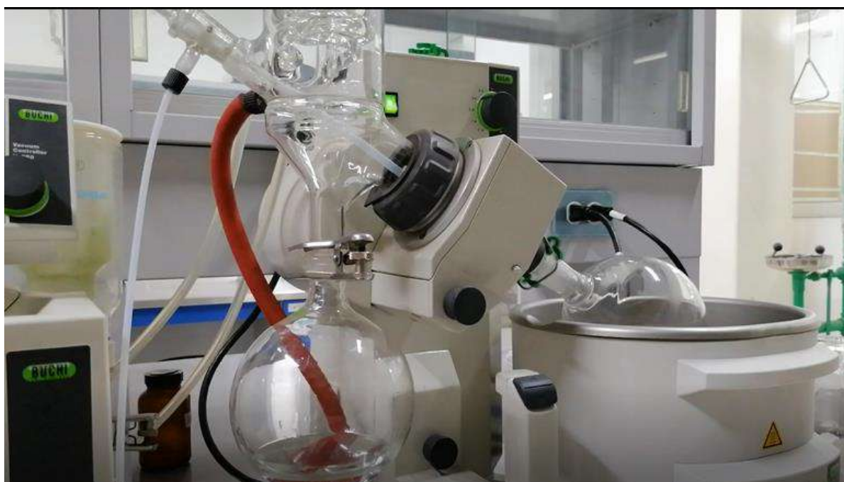
Figura 11 Evaporador rotativo utilizado para la purificación de los LIs
