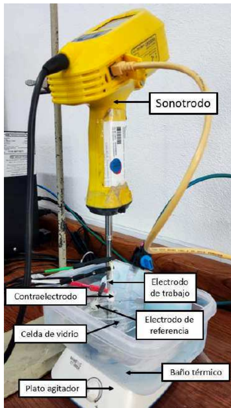
Figura 14. Sistema sonoelectroquímico utilizado en cada prueba.
