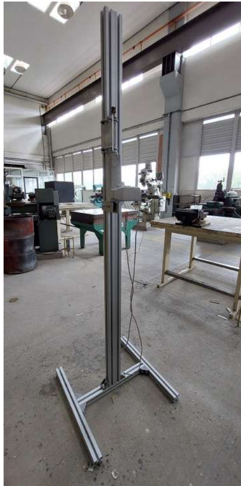
Figura 4.1: Estructura del sistema ópto-mecánico sin los componentes ópticos (elaboración propia).
