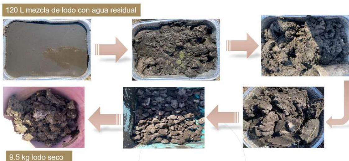
**Figura 3.** Proceso de secado de lodo
