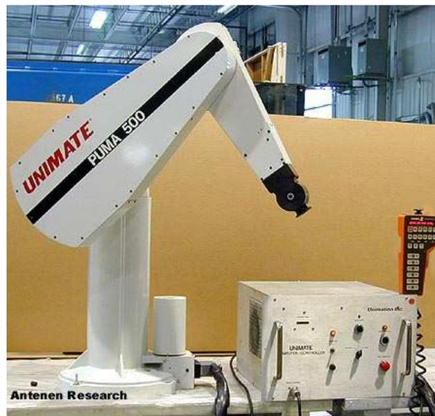
Figura 5.5 Robot Manipulador Comerciales de Uso General PUMA 500 UNIMATE
