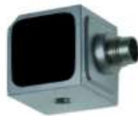
Figura 3.9 Acelerómetro empleado de la marca KISTLER® modelo 8395a (Autoría propia).
