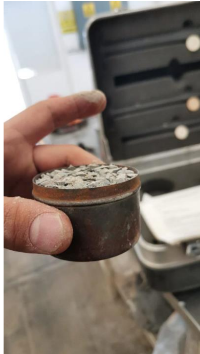
Figura 16. 80cm 3 de muestra agregado pétreo fino. Fuente: Elaboración propia
