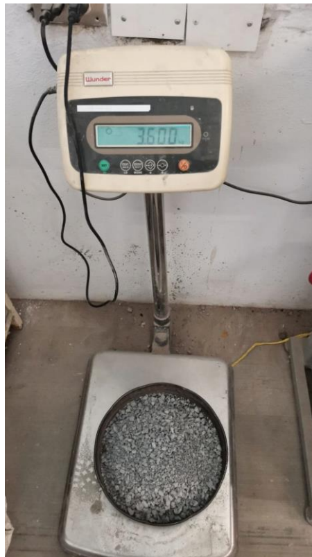
Figura 30. Peso retiene la malla #12". Fuente: Elaboración propia.
