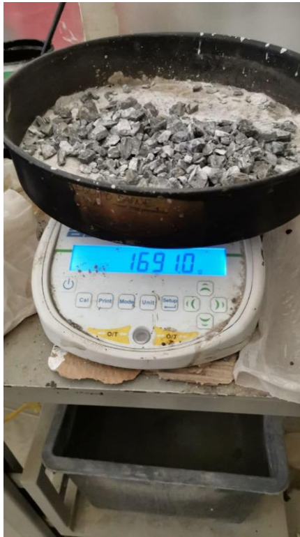
Figura 40. Agregado seco segundo día con peso de charola. Fuente: Elaboración propia
