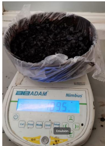
Figura 50. Contenido de emulsión asfáltica prueba A. Fuente: Elaboración propia.
