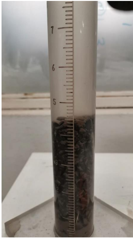
Figura 24. No se observan arcillas. Fuente: Elaboración propia.
