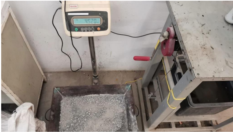
Figura 29. Agregado pétreo desgastado por máquina de los Ángeles. Fuente: Elaboración propia
