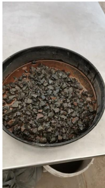
Figura 37. Después de intemperismo con sulfuro de magnesio. Fuente: Elaboración propia
