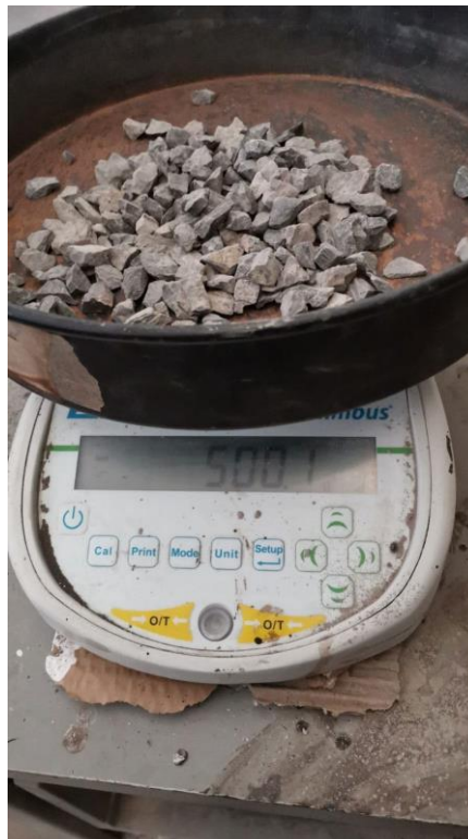
Figura 34 500gr retiene malla 1/2". Fuente: Elaboración propia
