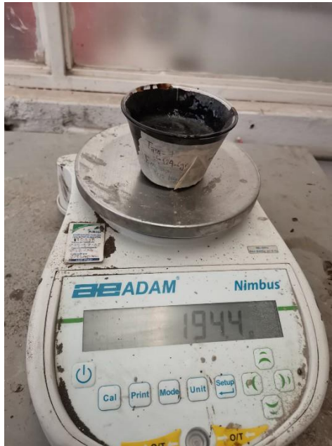
Figura 45. Peso final de cemento asfáltico. Fuente: Elaboración propia
