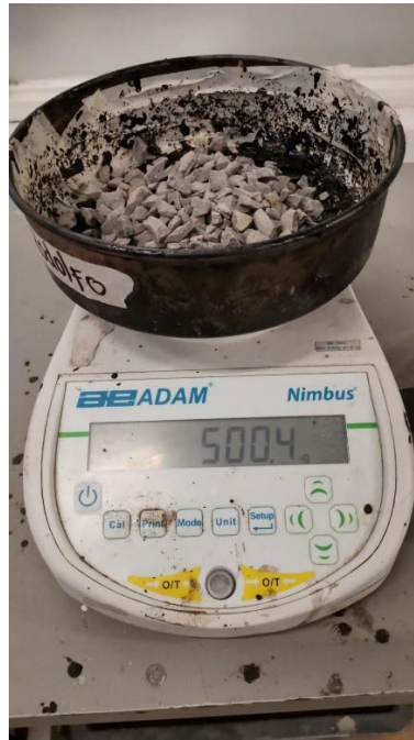
Figura 54 Cantidad de agregado pétreo prueba B. Fuente: Elaboración propia.
