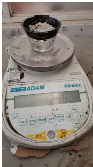
Figura 41. Peso flanera sin cemento asfáltico. Fuente: Elaboración propia.
