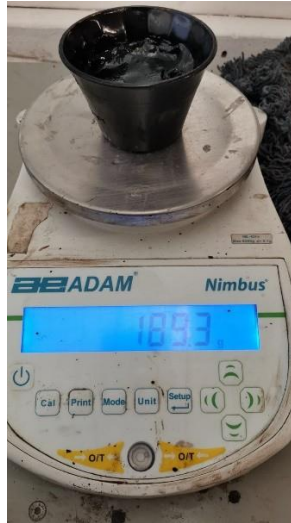
Figura 48. Asfalto sin agua ni emulsificante. Fuente: Elaboración propia.
