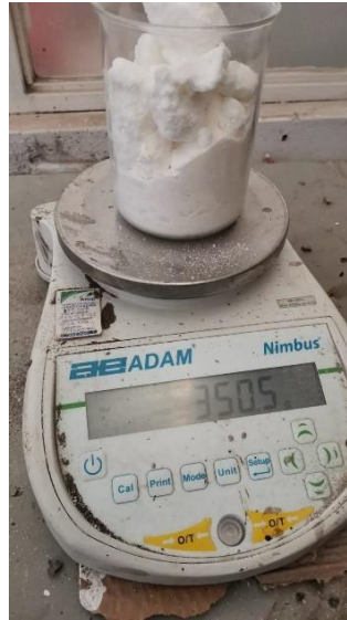
Figura 35. 350g de sulfato de magnesio en un litro de agua. Fuente: Elaboración propia
