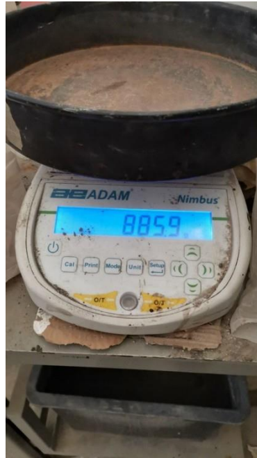
Figura 38. Peso de charola sin material. Fuente: Elaboración propia
