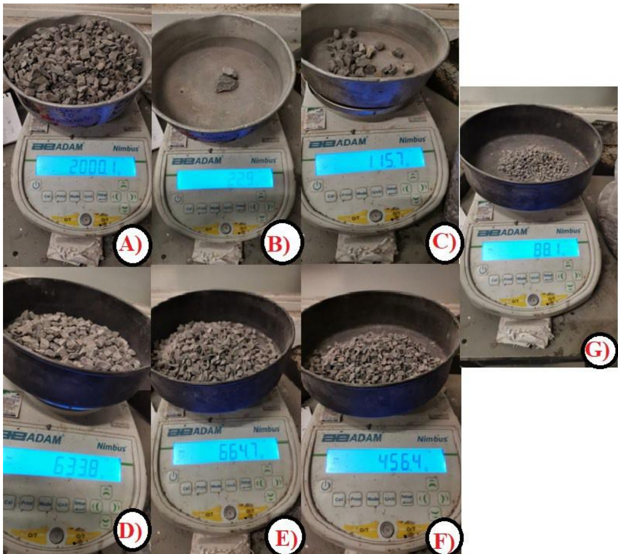
Figura 32 Muestra total A), Retiene malla ¾".B), Retiene malla ½" C), Retiene malla 3/8" D), Retiene malla ¼".E), Retiene malla #4 F), Retiene malla #6 G). Fuente: Elaboración propia
