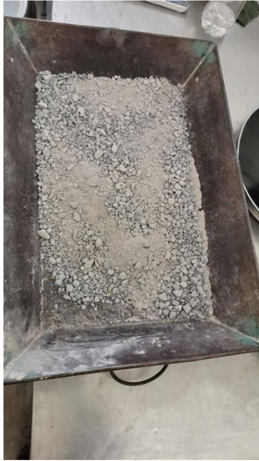
Figura 28. Después de pasar por máquina de los Ángeles. Fuente: Elaboración propia
