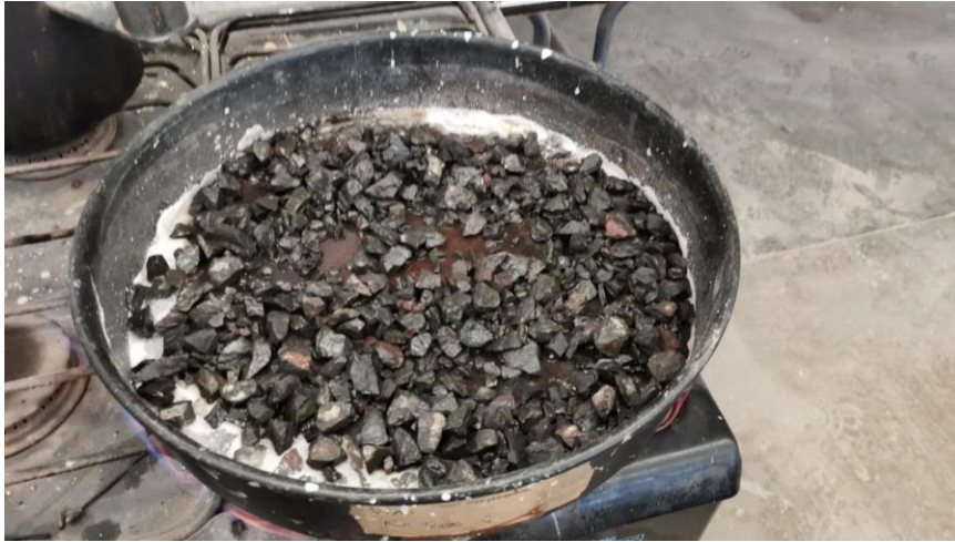
Figura 39. Material secándose en estufa para pesarse. Fuente: Elaboración propia
