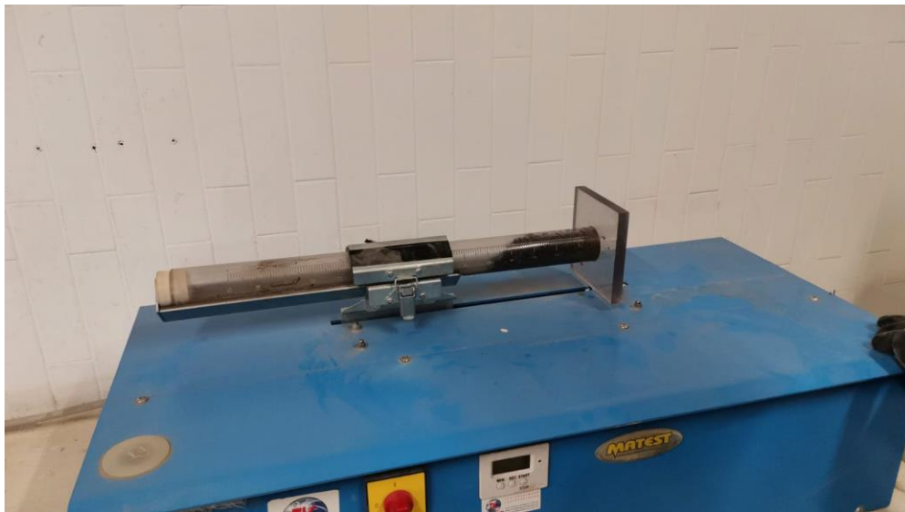
Figura. 22 Agitado equivalente de arena. Fuente: Elaboración propia
