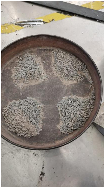
Figura 13. Cuarteo equivalente de arena. Fuente: Elaboración propia
