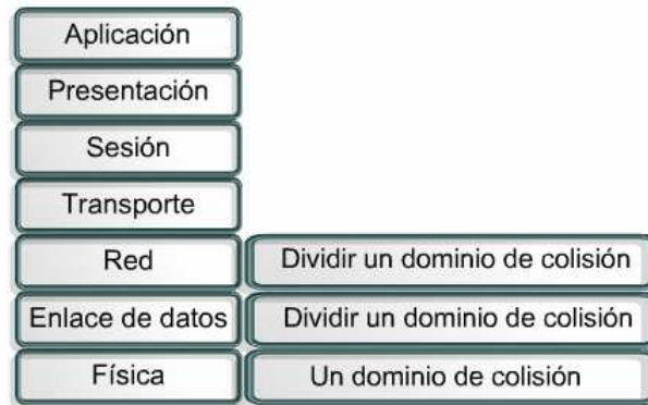
Figura 8.4 Segmentos del medio OSI en colisiones
