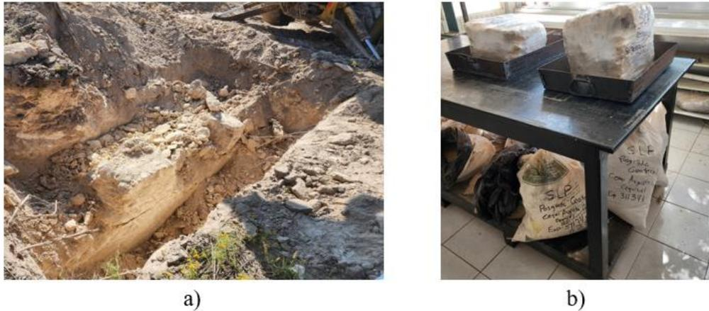
**Figura 24.** a) Extracción de muestras alteradas e inalteradas del suelo en estudio. b) Almacenaje de muestras en el cuarto de temperatura controlada.
