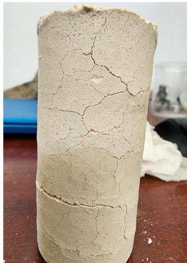
**Figura 60.** Agrietamiento presentado en probetas fabricadas con suelo mezclado con carbonato de sodio.
