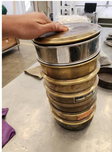
**Figura 30.** Análisis Granulométrico por tamizado.
