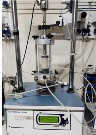
**Figura 41.** Prueba Triaxial CD
