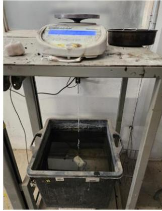
**Figura 27.** Determinación del peso específico del suelo.
