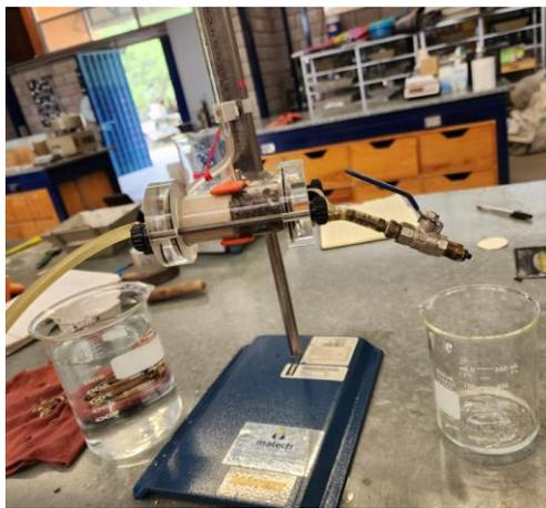
**Figura 37.** Prueba de Pinhole.
