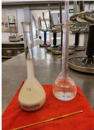
**Figura 28.** Determinación del peso relativo de sólidos.
