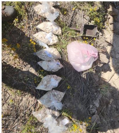
**Figura 25.** Muestras alteradas para obtener el perfil de humedad natural del sitio.
