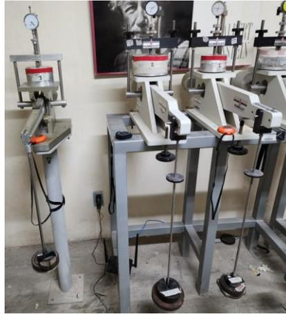
**Figura 39.** Prueba del Triple Odómetro.
