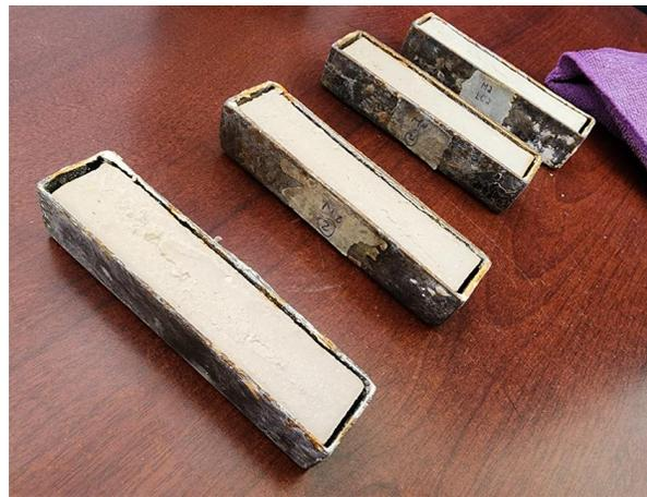
**Figura 33.** Determinación del Límite de Contracción Lineal y Volumétrica.
