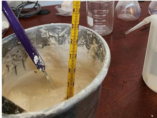
**Figura 45.** Reacción exotérmica observada al hidratar el material.
