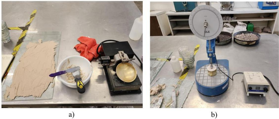
**Figura 32.** Determinación del Límite Líquido por el método a) Copa de Casagrande b) Cono Inglés
