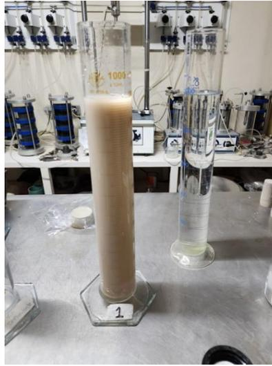
**Figura 31.** Análisis Granulométrico vía hidrómetro.
