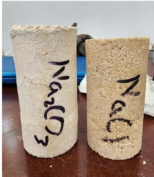
**Figura 62.** Comparación de probetas fabricadas con carbonato de sodio y cloruro de sodio.
