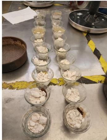
**Figura 26.** Muestras para la obtención del contenido de humedad del suelo.
