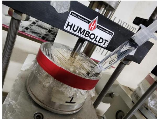
**Figura 40.** Incremento de humedad a la muestra.
