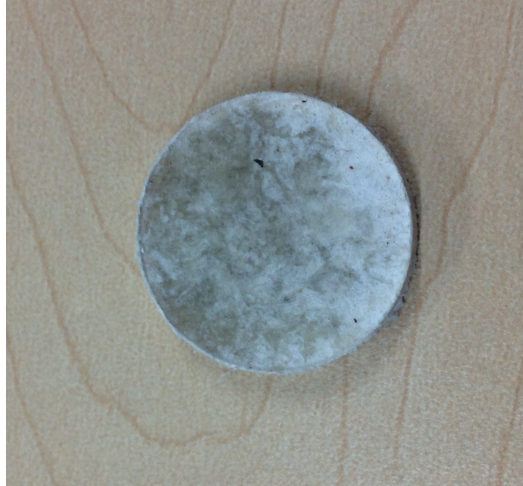
Fig. 6.10.- Pastilla elaborada con escamas trituradas
