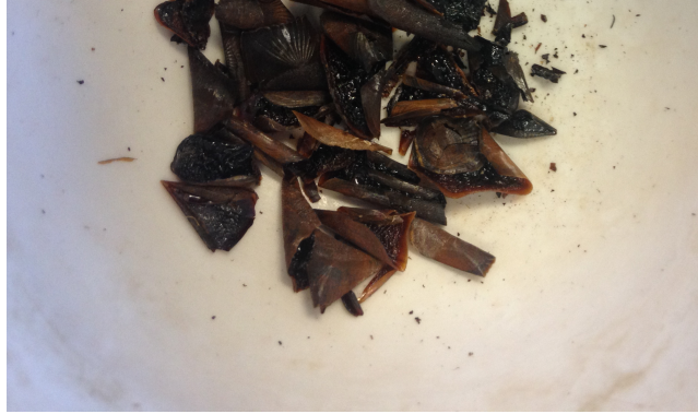
Fig. 6.5.- Calcinación de escamas a 200°C
