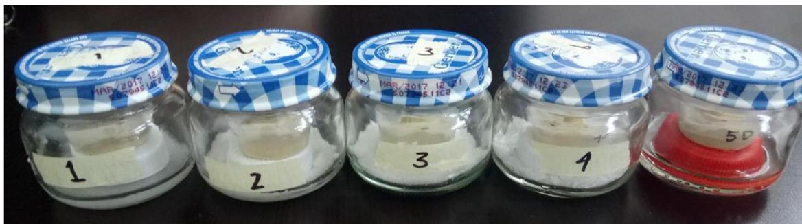
**Figura 4 Frascos para determinación del isoterma de sorción**
