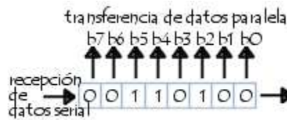
Figura 16. Transformación de Conexión de Serie a Paralela
