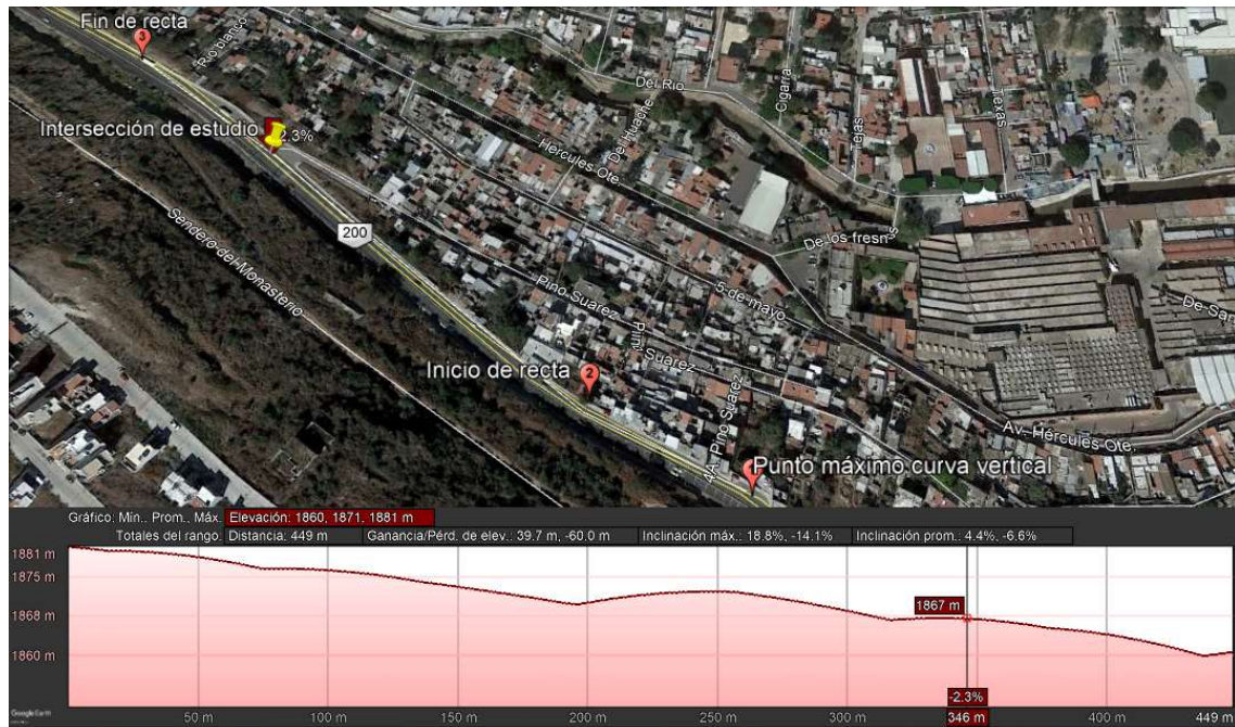
Figura 3.10. Perfil de elevación en la intersección semaforizada seleccionada.
