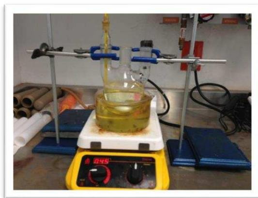
**Figura 3.1 Síntesis SBA-16 con agitación constante a temp. ambiente en un baño de aceite**
