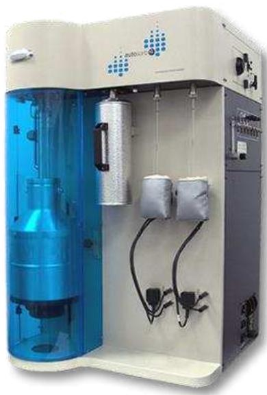
**Figura 3.4** Equipo autosorb Quantachrome iQ2
