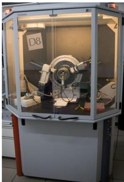
**Figura 3.3** Difractómetro Bruker D8 Advance
