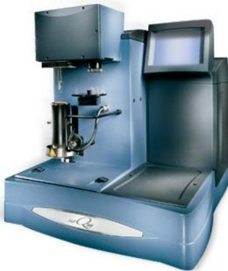
**Figura 3.7 Equipo TGA Q500 TA Instruments**
