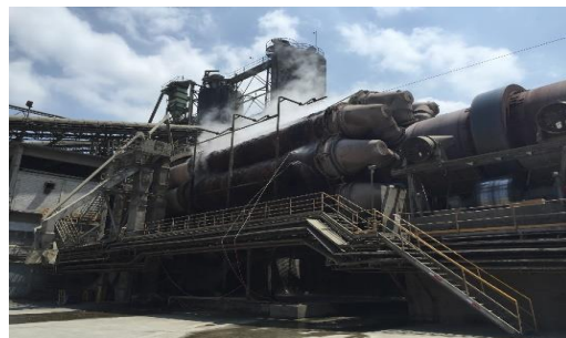
Figura 8. Efriador de Clínter de cemento (Fuente propia).
