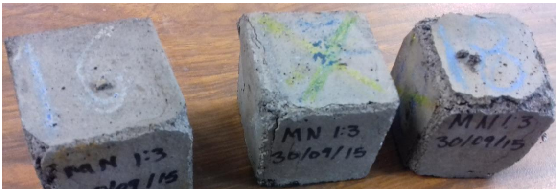
Figura 66.- Probetas de la mezcla MN 1:3, en el último ciclo, después de la prueba de compresión (Bautista León, 2015).
