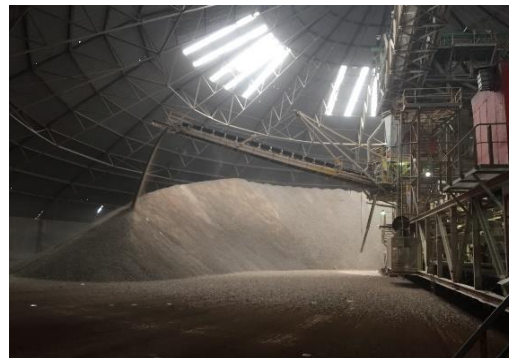
Figura 4. Prehomegenización de la materia prima, para elaborar cemento Portland (Fuente propia).
