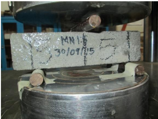
Figura 44.- Colocación de espécimen sobre la platina, lista para cargarla (Bautista León, 2017).
