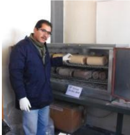
Figura 64.- Especímenes en horno, prueba de ataque acelerado por sulfato de sodio anhidro.
