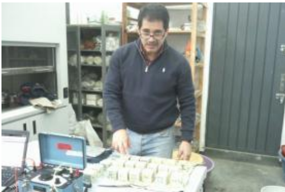
Figura 53.- Determinación de la Resistividad Eléctrica.
