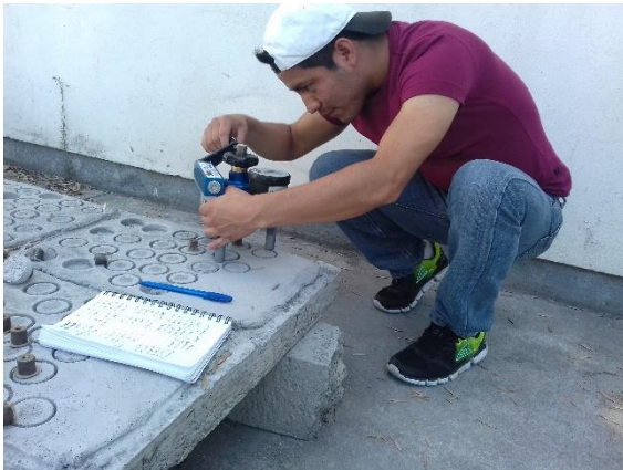
Figura 49.- Determinación de la resistencia al despegue con el equipo Pull-off (Bautista León, 2017).
