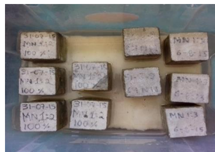
Figura 56.- Probetas en prueba de absorción capilar.
