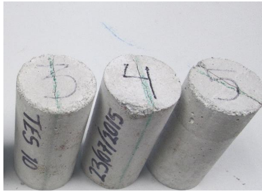
Figura 48.- Fallas de las probetas evitado que sea por impacto (Bautista León, 2015).
