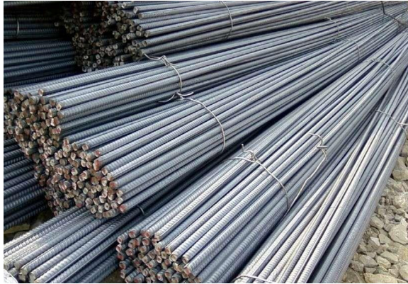
Figura 15.-Acero de refuerzo para concreto. Fuente: http://spanish.structural-steelbuilding.com
