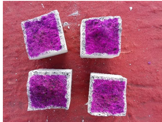
Figura 54.- Aplicación de fenolftaleína para verificar la carbonatación (Bautista León, 2015).
