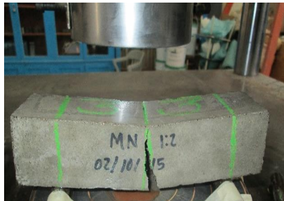
Figura 45.- Rotura de la probeta justo en la marca (Bautista León, 2017).
