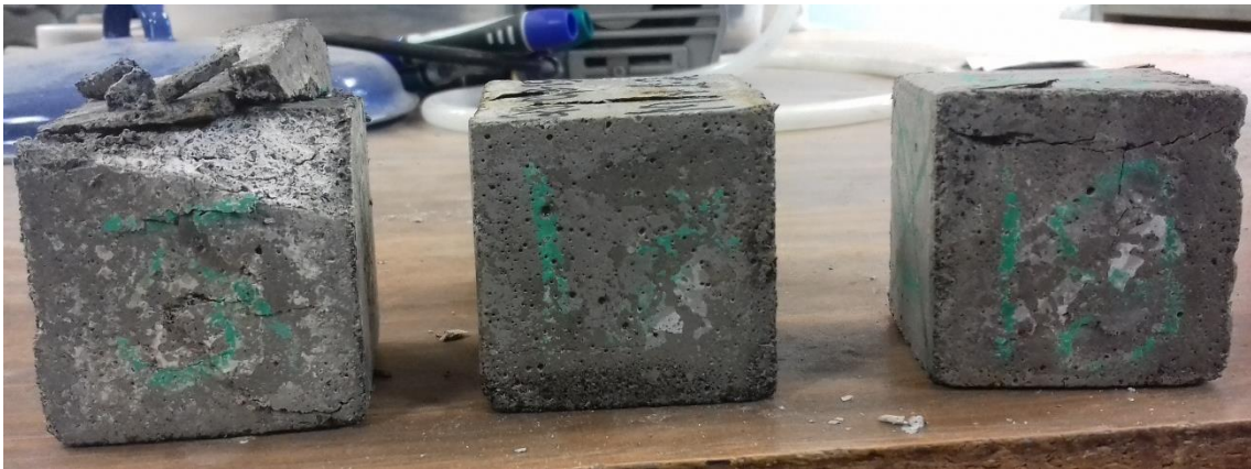
Figura 65 .- Probetas de la mezcla "Control" en el último ciclo, después de la prueba de compresión (Bautista León, 2015).
