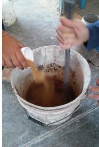
Figura 40.- Fluidificante CRISOTAN R-5 homogenizado en el agua para la elaboración de especímenes, (Contreras M.E., 2016).
