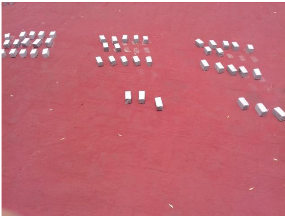
Figura 55.- Exposición de probetas a la intemperie (Bautista León, 2015).
