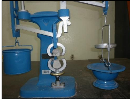
Figura 46.- . Ejecución de la prueba de tensión directa.
