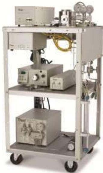
**Figura 12. Equipo de fluidos supercríticos Thar Waters**
