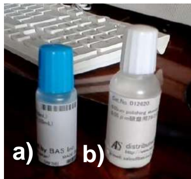
Figura 10. a) Suspensión de diamante con tamaño de partícula de 1\mu\text{m} . b) suspensión de alúmina con tamaño de partícula de 0.05\mu\text{m} .
