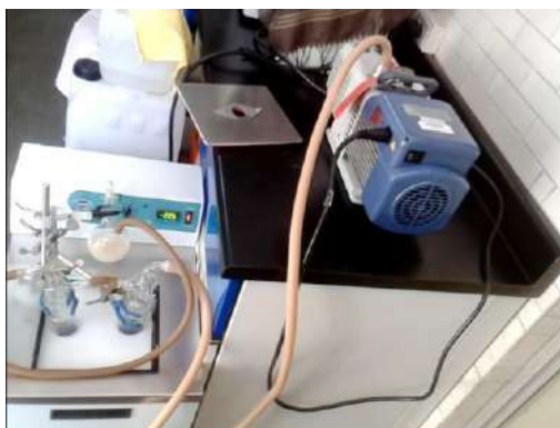
Figura 4. Secado al vacío del catión N-(2-hidroxiethyl)-N-(2-etilhexil)-N,N-dimetilamonio.
