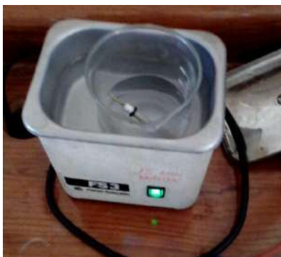
Figura 11. Baño de limpieza por ultrasonido del electrodo de platino.
