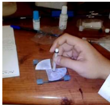
Figura 9. Método de pulido del electrodo de trabajo (platino).
