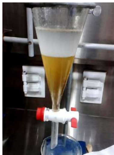
Figura 5. Extracción de la fase orgánica correspondiente al líquido iónico [\text{C}_8\text{ramChol}]^+[\text{NTf}_2]^- .
