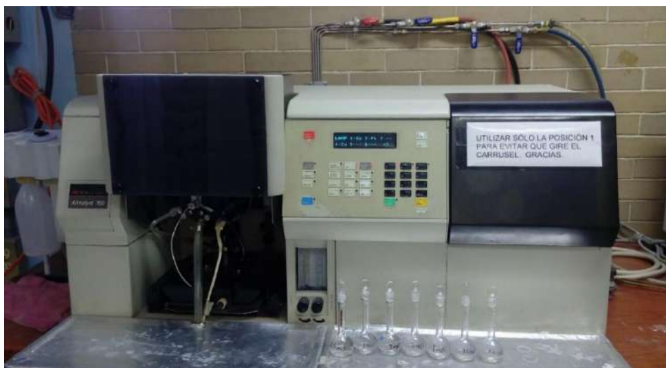
Figura 10. Equipo de absorción atómica de flama PERKIN ELMER AAnalyst 100 usado para la cuantificación de las especies de interés.
