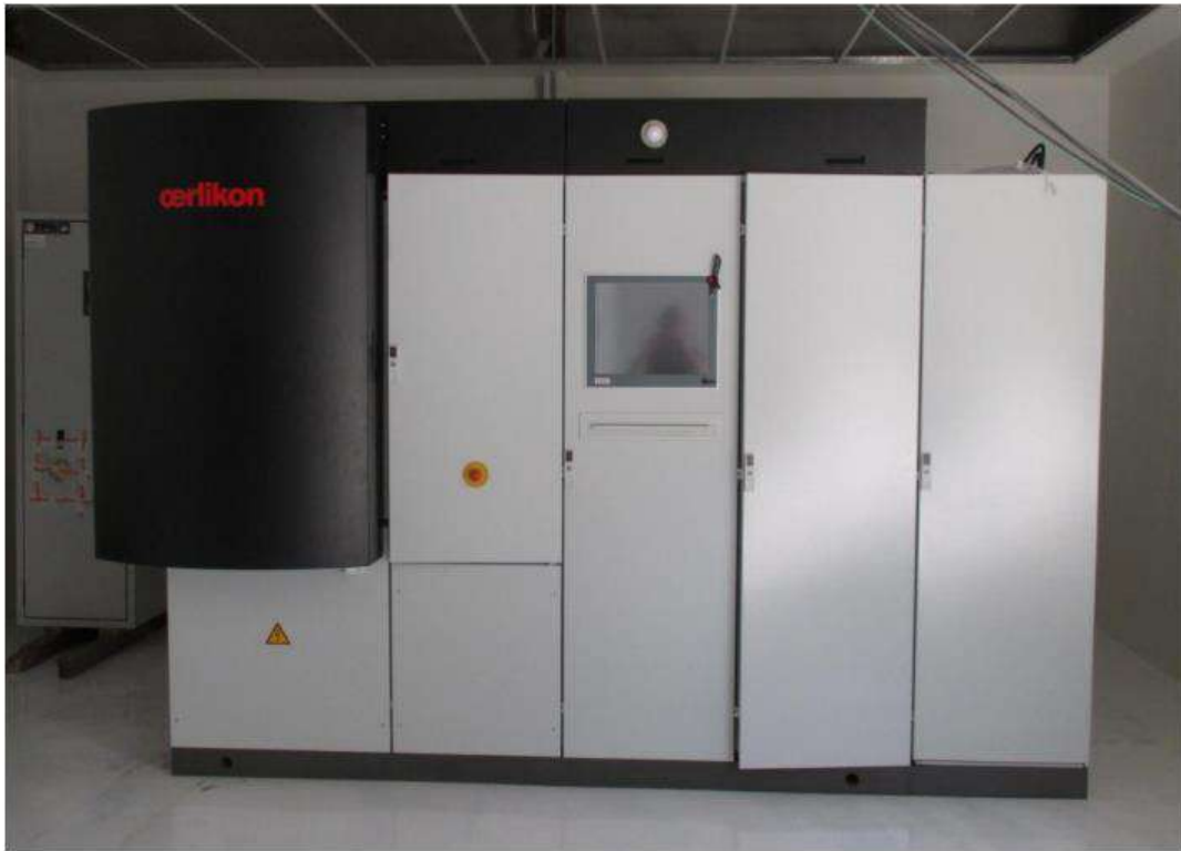
Figura 12. Equipo PVD de arco Domino Mini de Oerlikon Balzers utilizado para la deposición de los recubrimientos Ti_{1-x}Al_xN .
