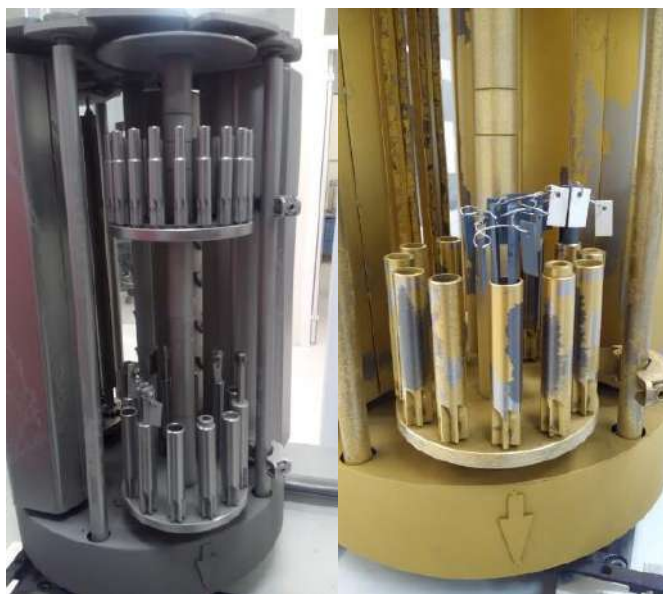
Figura 14. Sistema planetario rotatorio donde se coloca el arreglo de los sustratos mostrados en la Figura 13.
