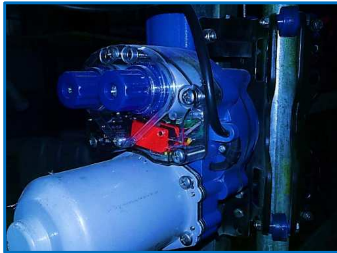
Figura 6. 4. Moto-reductores (24 VCD, 100 N/m).
