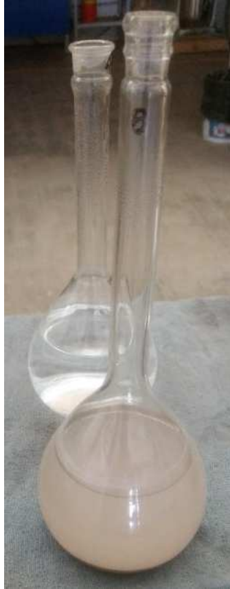
Figura 3-2.- Prueba de Hidrómetro.
