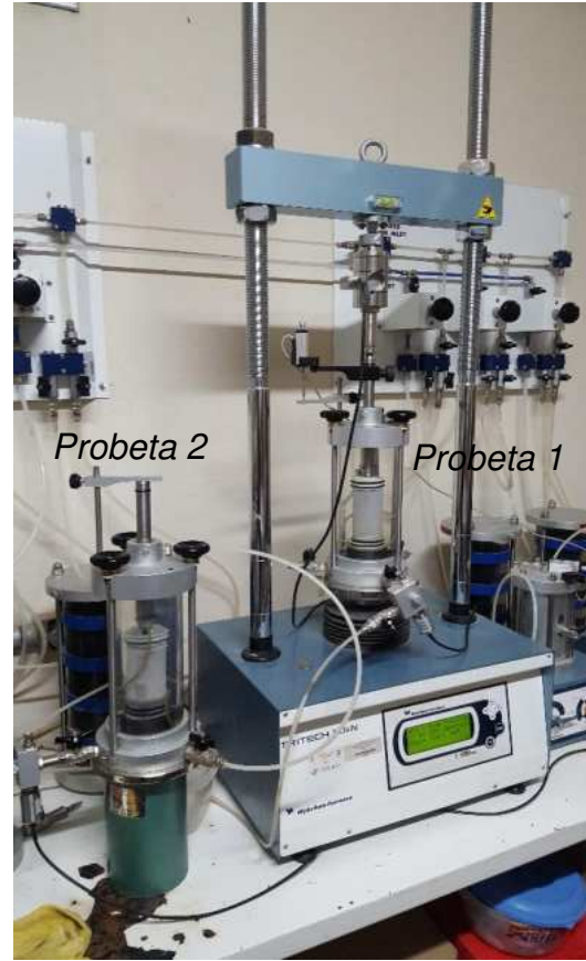
Figura 3-5 Cámaras triaxial, a) probeta en consolidación. b) Probeta 1 en consolidación y probeta 2 en saturación.
