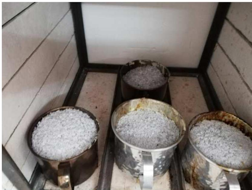
Fig. 20. Proceso de termofusión del PET después de 60 minutos.
