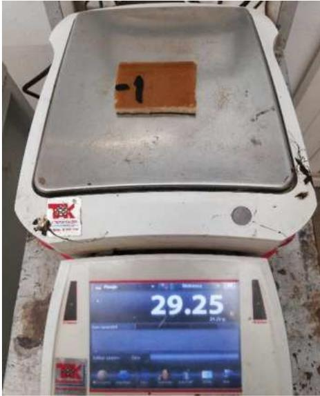
Fig. 26. Pesado de probeta de PET
