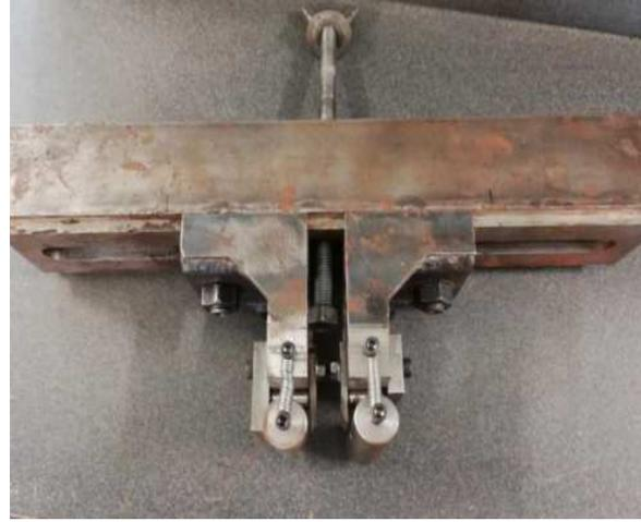
Fig. 25. Rodillos de carga para pruebas a flexión
