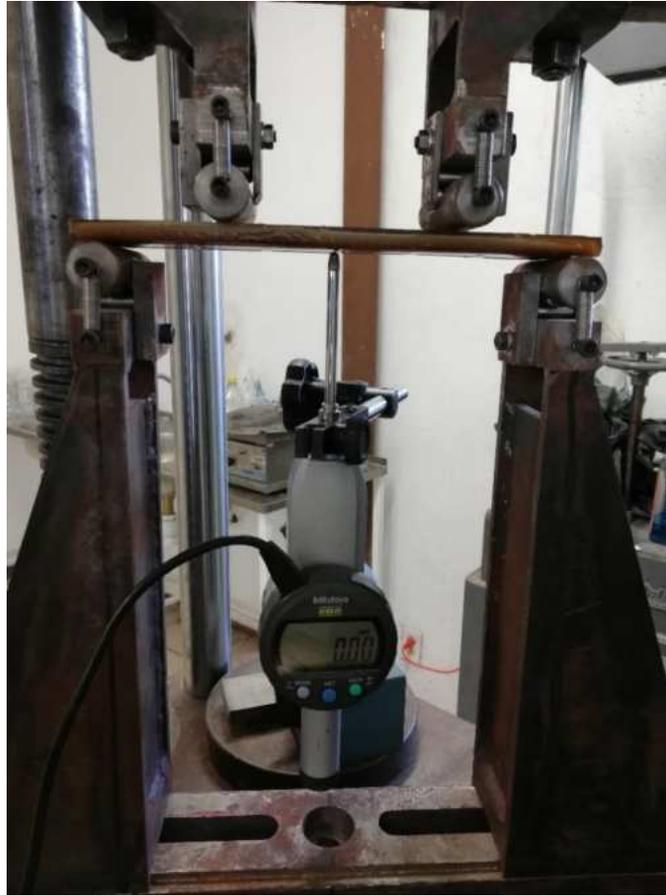
Fig. 29. Prueba de flexión a probeta de PET
