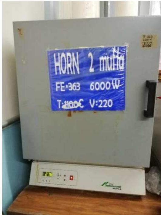
Fig. 19. Mufla utilizada para termofusionar el material PET fijada a 275°C
