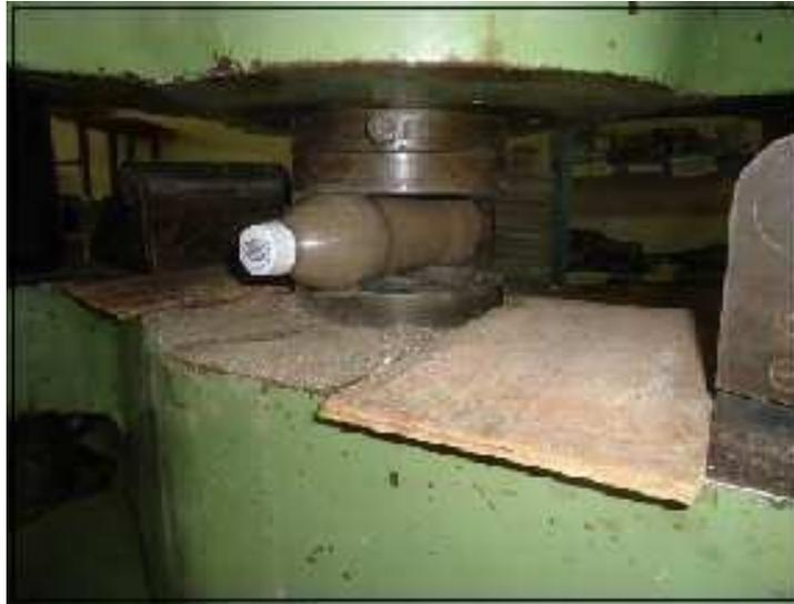
Fig. 8. Prueba aplicada en botellas de PET de desecho llenas de suelo y cerrado herméticamente (Rawat et al. 2014).
