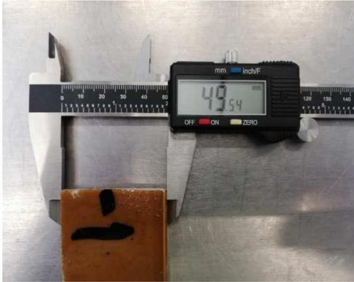
Fig. 27. Medición de anchura de probeta de PET
