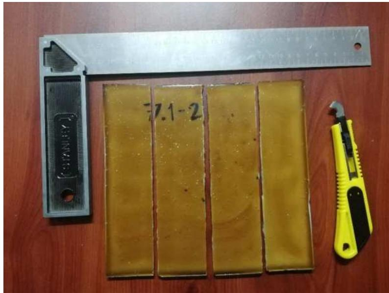
Fig. 22. Panel medido y cortado transversalmente con cuchilla.
