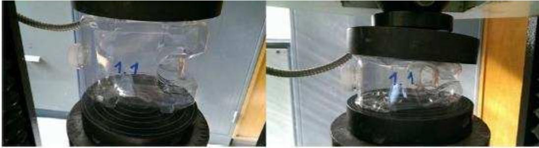
Fig. 10. Desempeño de la botella con 0.2 kN y 1.2 kN de carga respectivamente (Nováková et al. 2017)
