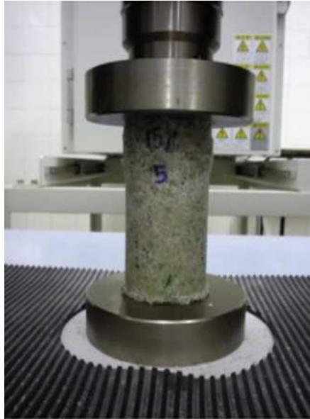
Fig. 13. Ensayo a Compresión de Especímenes de resinas epoxi-arena-PET triturado (Reis y Carneiro, 2012)
