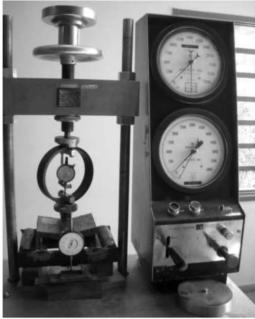
Fig. 17. Ensayo a resistencia a flexión de panel con residuos plásticos y resinas nauticas (Gaggino, 2012).
