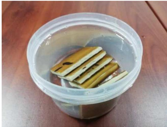
Fig. 28. Inmersión de probetas de PET en agua
