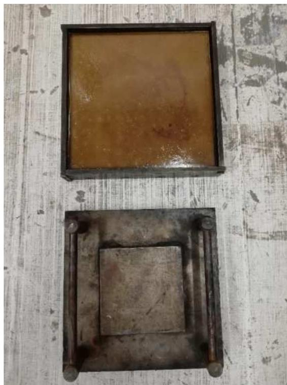
Fig. 22. Molde metálico destapado una vez endurecido el material PET
