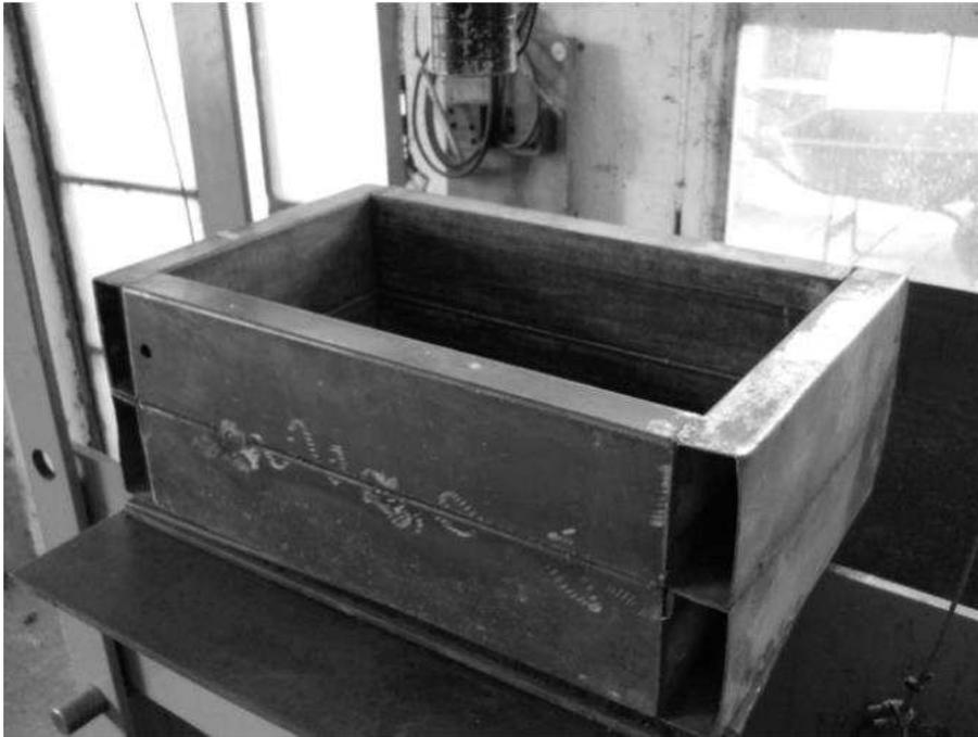
Fig. 14. Molde metálico utilizado en la mezcla de desechos plásticos con resina náutica. (Gaggino, 2012)
