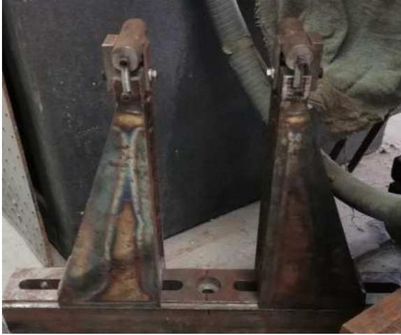
Fig. 24. Rodillos de apoyo para pruebas a flexión
