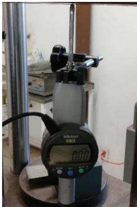
Fig. 23. Micrómetro digital utilizado para medir la deflexión.
