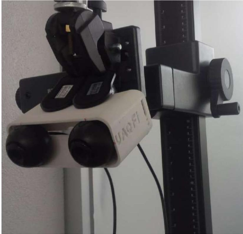
Figura 5.2 Montaje de cámaras a la distancia adecuada.
