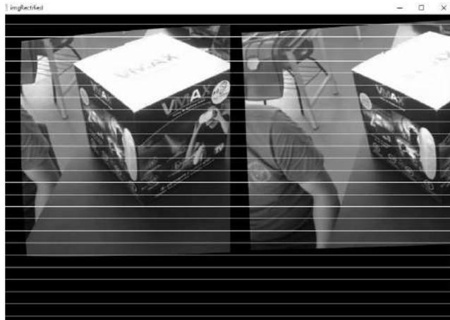
Figura 5.5. Imágenes rectificadas con puntos de coincidencia corregidos.
