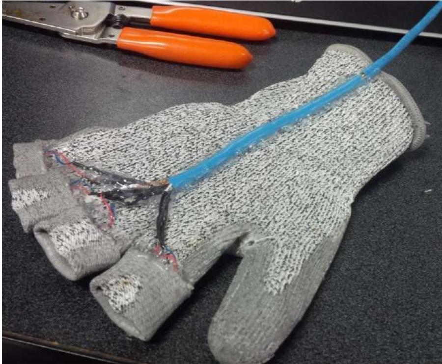
Figura 5.6. Colocación de actuadores de vibración.
