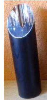
**Prototipo 4** El captador se compone por una placa elíptica de vidrio traslúcido sujeta al conducto de Ø10cm x 24 cm de longitud fabricado con lámina de aluminio cal. 26, que conecta a un difusor de biopolímero PLA con una placa circular de polipropileno de Ø10 cm.
