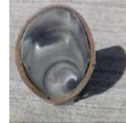
Prototipo 4.3 Variación del prototipo 4 al forrar el conducto con película maylar autoadherible en su interior.
