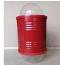
**Prototipo 1.1** Variación del prototipo 1 en cuanto al difusor que es circular plano de acrílico translúcido además el interior se forro de película color plata.
