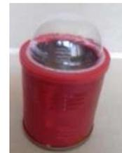
**Prototipo 2** Está compuesto por un captador con una cúpula de cristal grueso, con un anillo de sujeción plástico que conecta a un cilindro metálico de Ø10cm x 12 cm de longitud (conducto) el cual sostiene otro anillo plástico con un difusor compuesto por una placa de acrílico translúcido circular.
