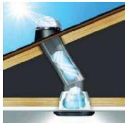
Figura 11. Sistema Solatube. Fuente: Everlux, S.A. de C.V. (2005)
