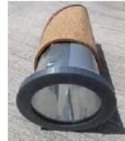
Prototipo 4.2 Variación del prototipo 4 al forrar el conducto con película maylar autoadherible en su interior y utilizar un difusor de acrílico traslúcido.
