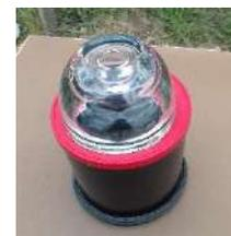
Prototipo 2.1 Variación del prototipo 1 en cuanto al revestimiento interior el cual se forro de película color plata.
