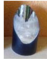
Prototipo 3.2 Variación del prototipo 3 en cuanto a la longitud del conducto de 30 cm a 40 cm.
