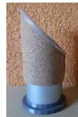
Posee una cubierta exterior de aislante de corcho de 4mm con una longitud de 16 cm.
