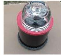
**Prototipo 3** La zona de captación ahora con un corte a 44° se compone por una cubierta elíptica de acrílico traslúcido que dirige la luz hacia el conducto de Ø10cm x 30 cm de longitud forrado en su interior por una película plástica color plata. El difusor se forma por una placa circular de acrílico traslúcido.
