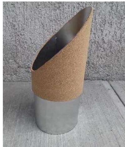
Figura 55. Colocación de aislante de corcho de 6mm
