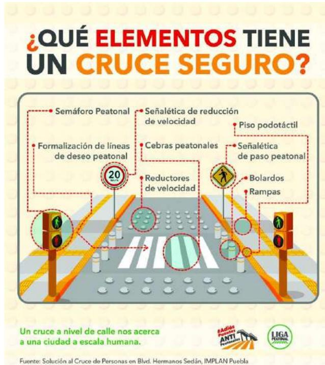
**Figura 2.6** elementos de seguridad del peatón.
