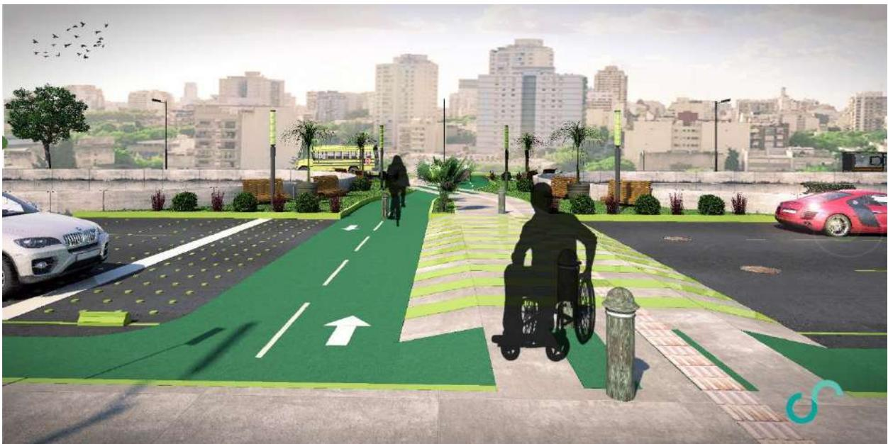
**Figura 7.21** Vista frontal del paso ciclo-peatonal donde se observa la sección que está a nivel y los señalamientos horizontales de precaución.
