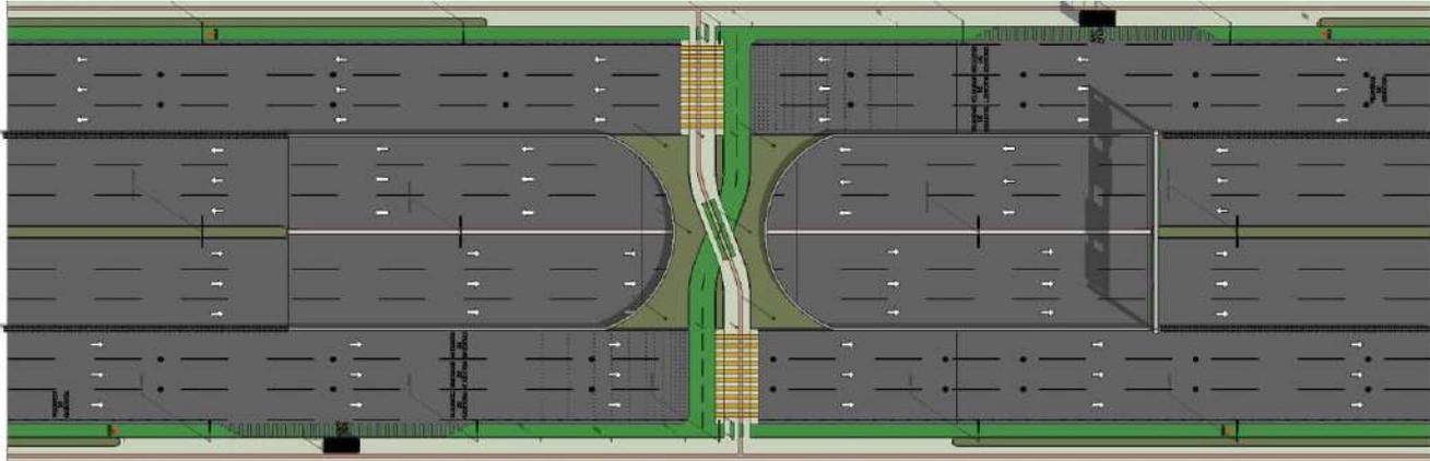
**Figura 7.14** modelo 2 con paso peatonal a nivel y vías rápidas en un paso deprimido.
