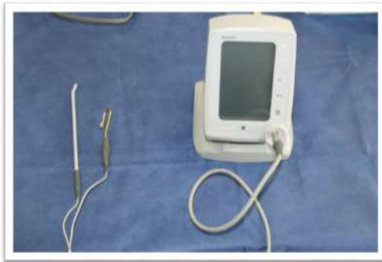
Figura 4. Unidad de Diagnóstico de Elementos y Localizador de Ápices(SybronEndo ®) donde se observa el diodo emisor de la corriente y el gancho.
