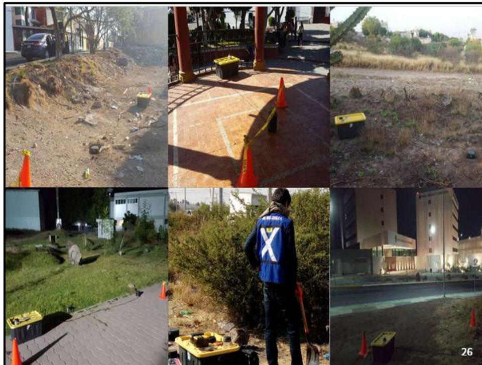
Figura 4.8 Colocación del sismógrafo para el registro en campo.
