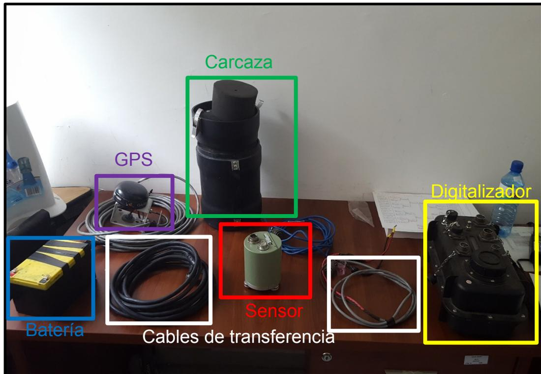
Figura 4.3 Componentes básicos del sismógrafo utilizado en las mediciones.
