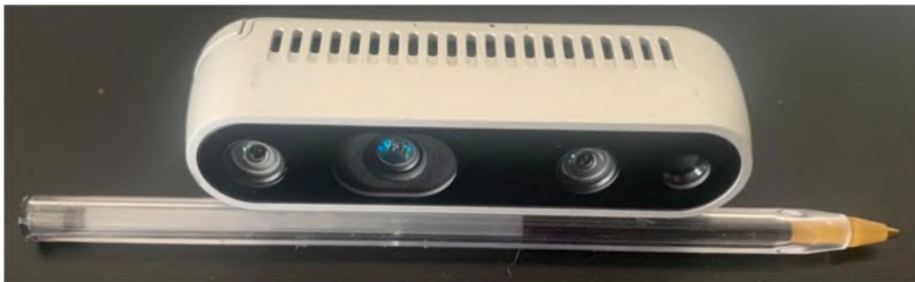
90 mm - ancho x 25 mm - largo x 25 mm - alto Intel Realsense D435
