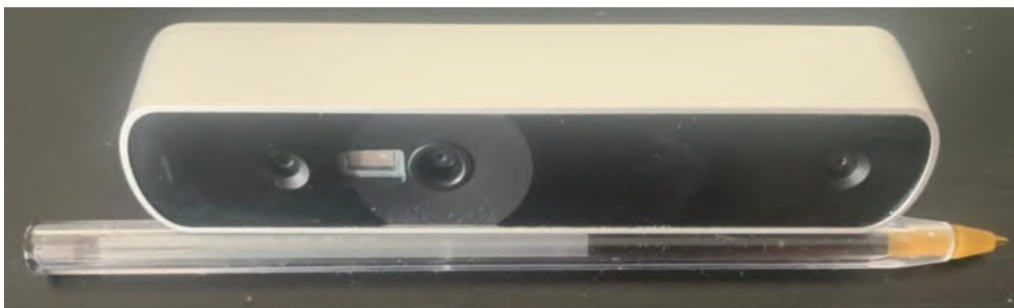
109 mm - ancho x 18 mm - largo x 24 mm - alto Structure Core
