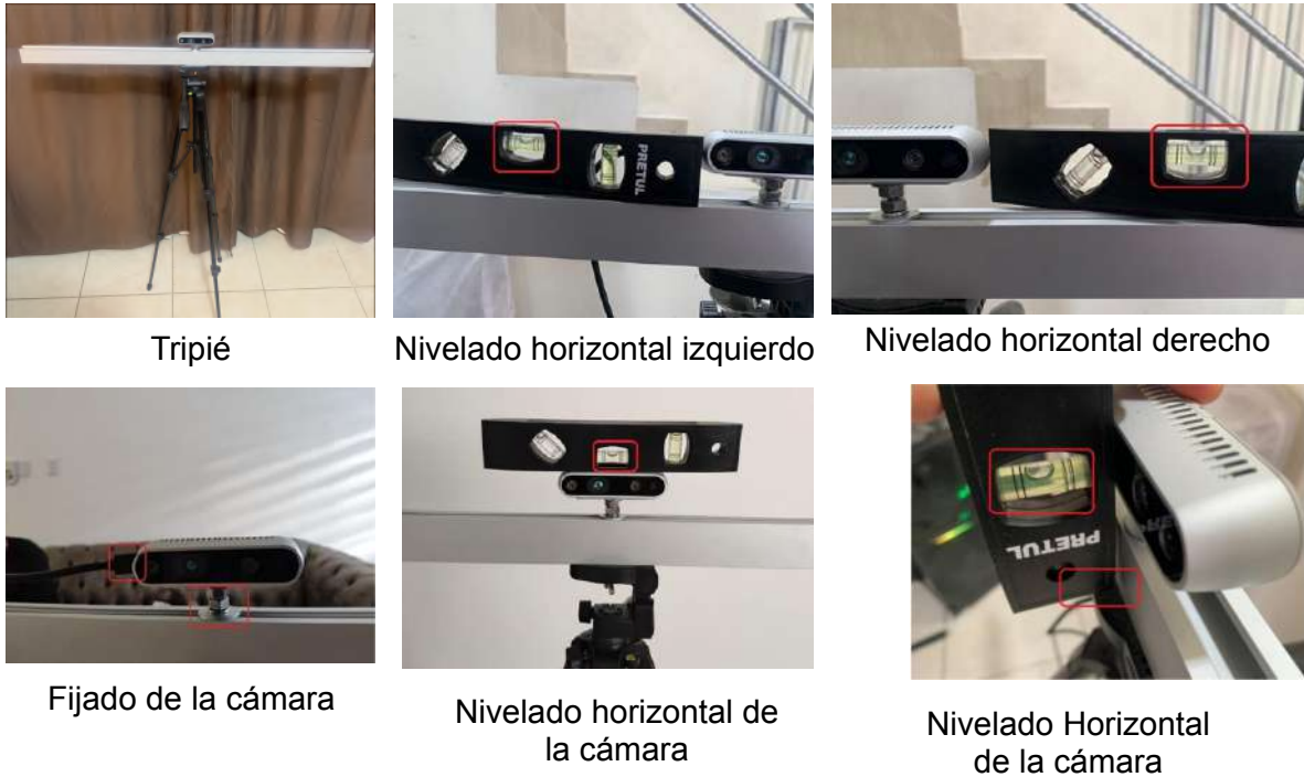
Figura 3.7: Configuración de la cámara y tripié.
