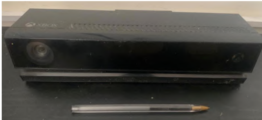
249 mm - ancho x 66 mm largo x 67 mm - alto Kinect V2
