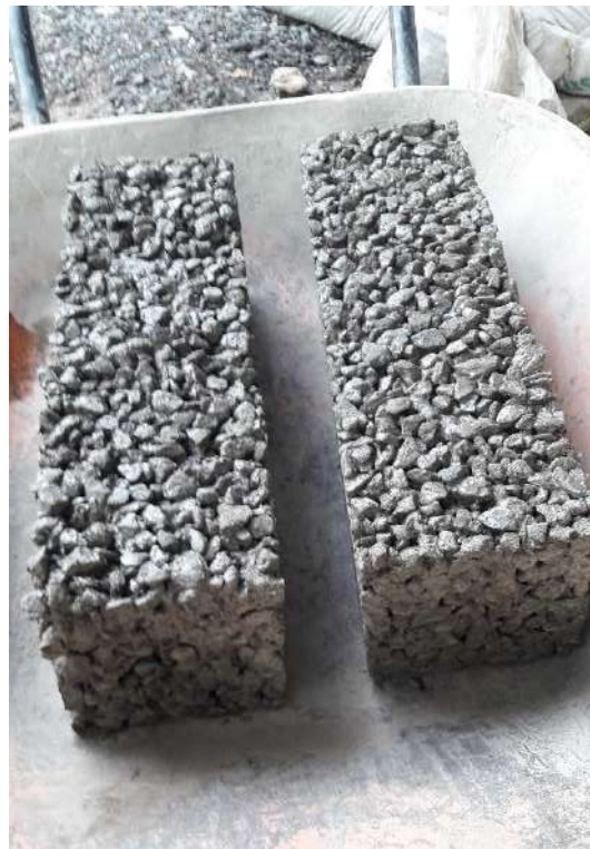
Figura 3.10. Vigas desmoldadas listas para curar. Fuente: Elaboración propia
