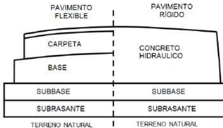
Figura 2.1 Estructuración típica de pavimentos. Fuente: (SCT)
