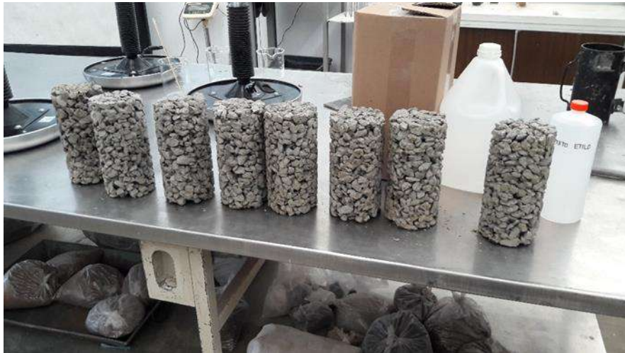
Figura 3.8. Muestra de cilindros desmoldados y listos para curar. Fuente: Elaboración propia
