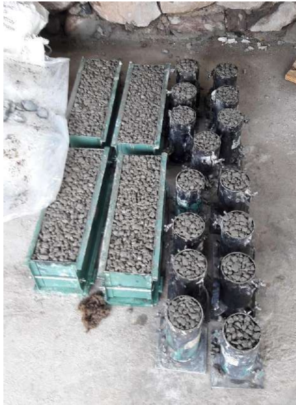
Figura 3.7. Cilindros y Vigas antes de ser desmoldados.
