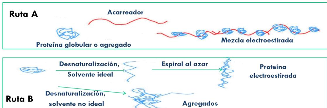
**Figura 2.** Mecanismos propuestos de electroestirado de proteínas (Adaptado de Nieuwland *et al.*, 2013).
