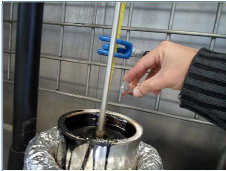
Figura 4-7. Forma en la que se adicionó el azufre a la mezcla asfalto-polímero.
