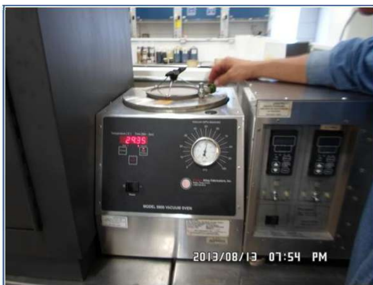
Figura 4-14. Inicio del proceso de eliminación de burbujas de las muestras de asfalto.
