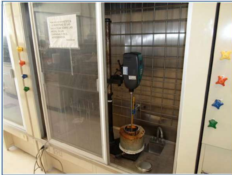
Figura 4-3. Equipo montado para la realización de la mezcla del asfalto.
