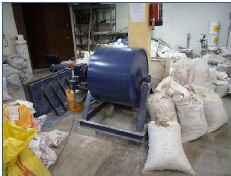
Figura 4-34. Proceso de trituración del material en la máquina de Los Ángeles.
