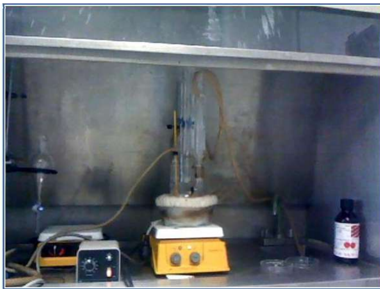
Figura 4-2. Proceso de reflujo de los reactivos una vez incorporado el ácido abiético (Hernández-Padrón et al., 2002).
