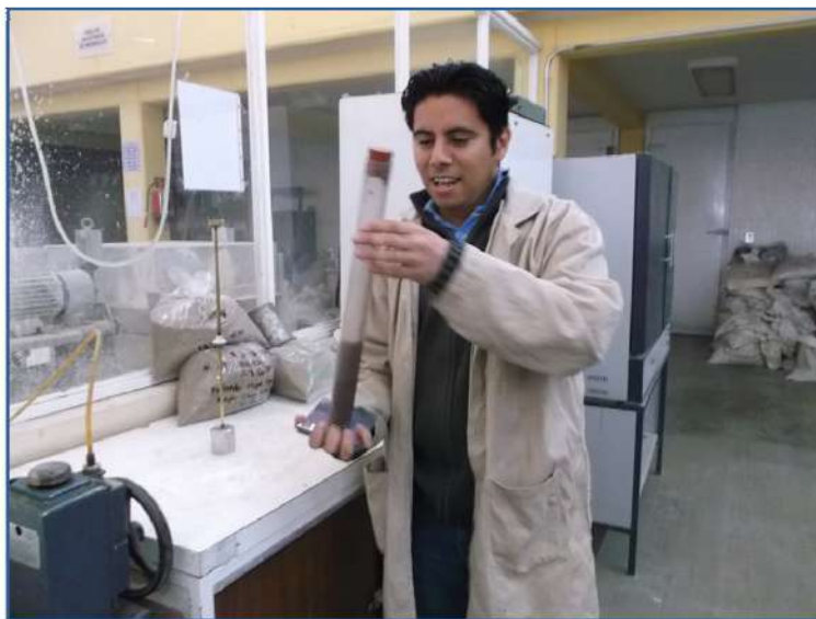
Figura 4-35. Proceso de agitado del cilindro con la muestra y la solución.
