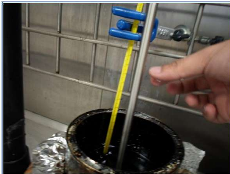
Figura 4-4. Proceso de incorporación del polímero SBS al asfalto.
