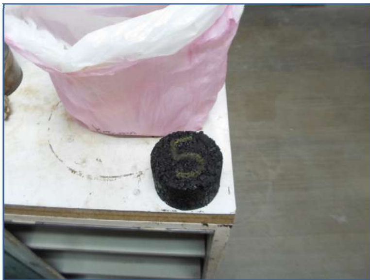
Figura 4-39. Proceso de enfriamiento de pastilla.
