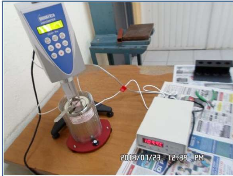
Figura 4-31. Proceso de rotación de la geometría empleada del viscosímetro.
