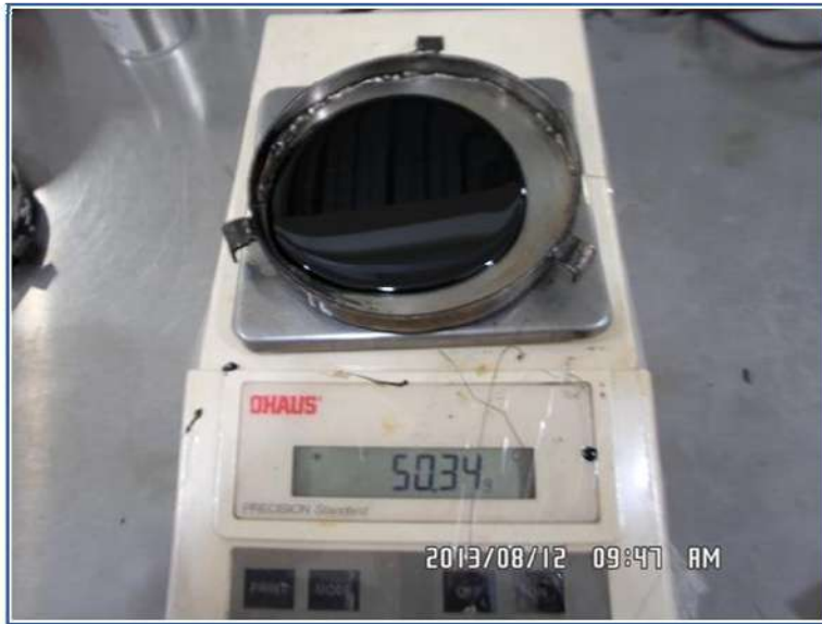
Figura 4-10. Colocación de la muestra en la charola de prueba y proceso de pesado de la misma.
