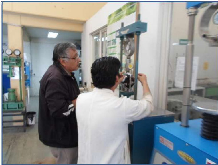
Figura 4-44. Ensayo de Estabilidad y Flujo en proceso.
