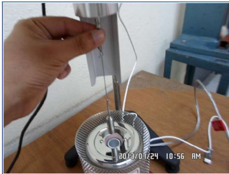
Figura 4-30. Colocación de la geometría dentro del recipiente con muestra.
