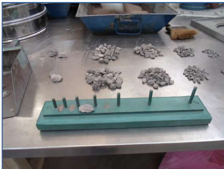
Figura 4-33. Retención del material pétreo en el calibrador del ensaye de partículas alargadas.
