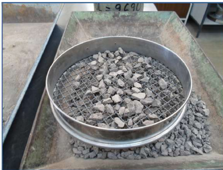
Figura 4-32. Proceso de cribado del material pétreo.
