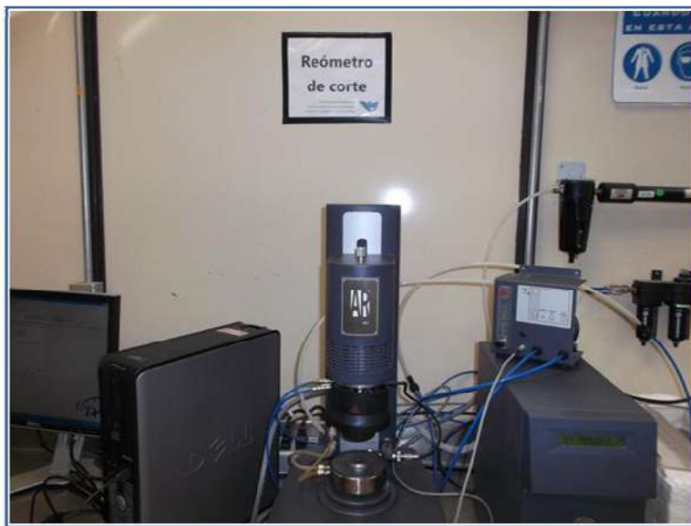
Figura 4-27. Preparación del reómetro para la realización del ensaye de módulo de corte dinámico.
