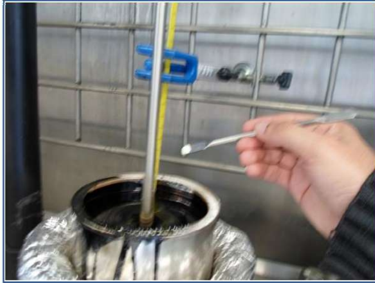
Figura 4-7. Forma en la que se adicionó el azufre a la mezcla asfalto-polímero.
