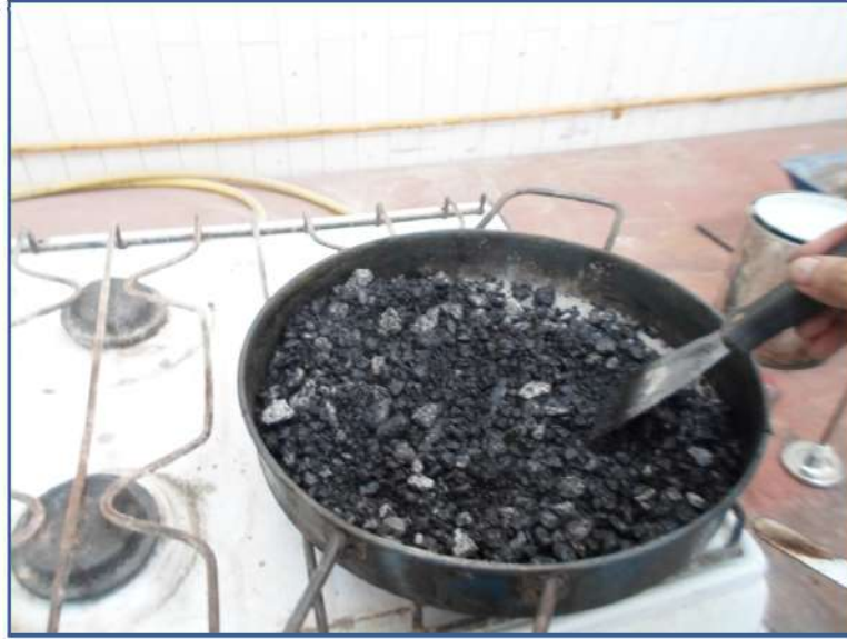
Figura 4-38. Proceso de mezclado del agregado pétreo con el asfalto.
