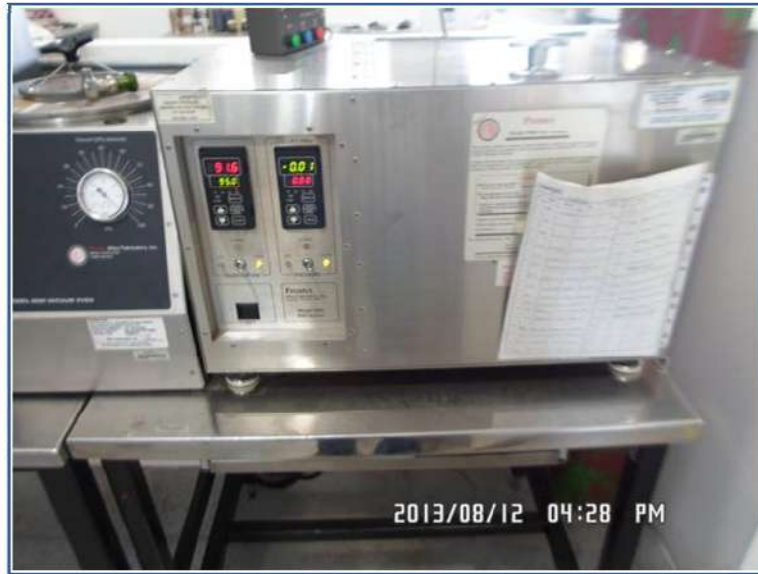
Figura 4-12. Encendido y fijación de los valores de presión y temperaturas en el recipiente a presión.
