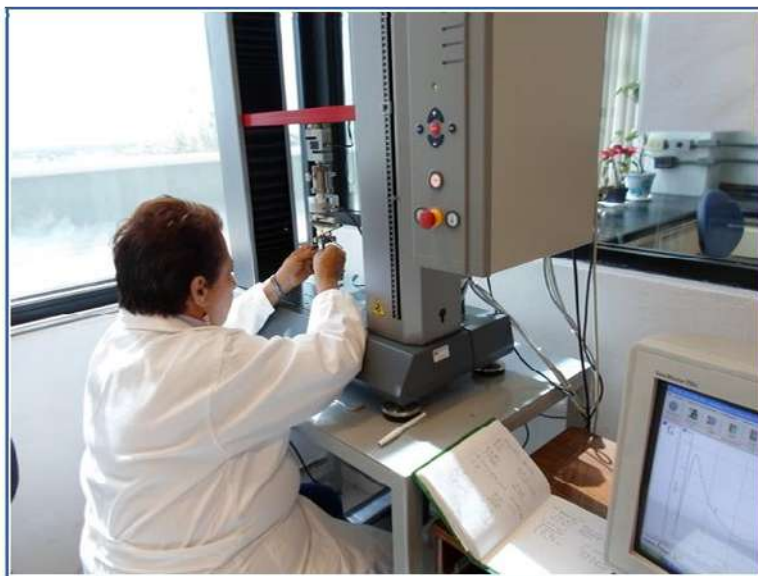
Figura 4-24. Colocación de la muestra en el equipo de tracción.
