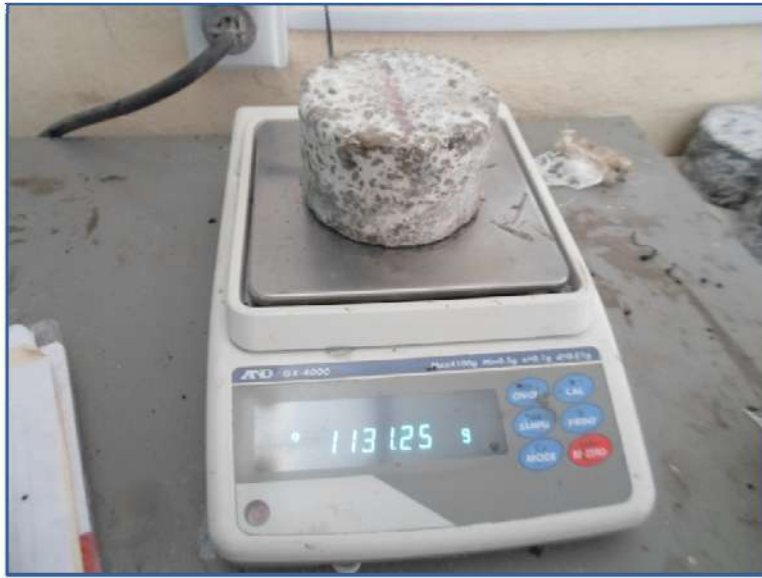
Figura 4-42. Peso de la pastilla cubierta con parafina al aire.
