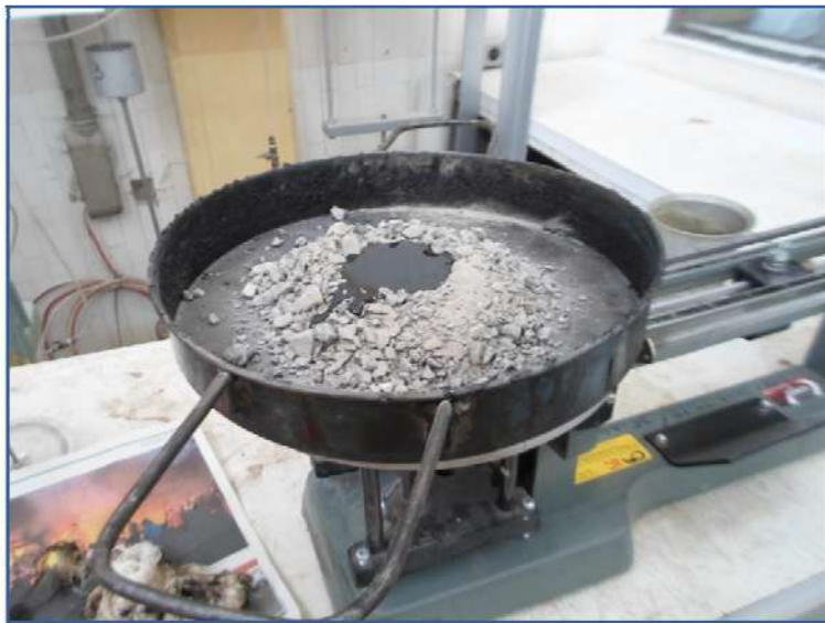
Figura 4-37. Incorporación del asfalto al agregado pétreo.
