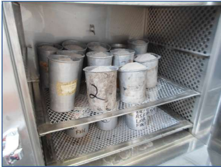
Figura 4-36. Calentamiento del agregado pétreo en el horno.
