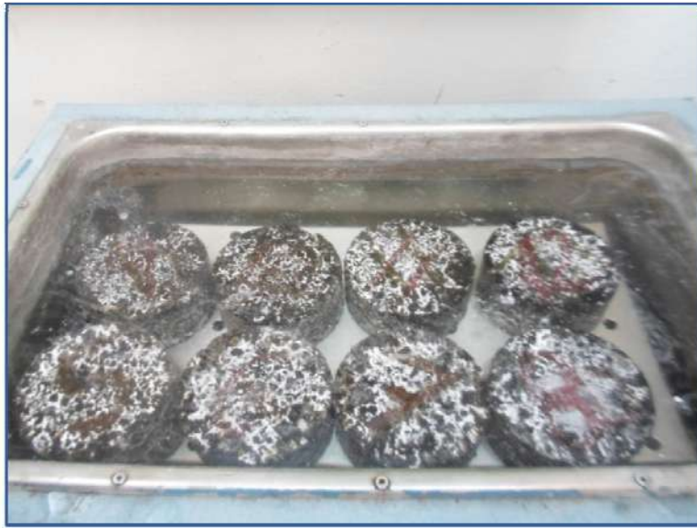
Figura 4-43. Especímenes en saturación a 60°C.
