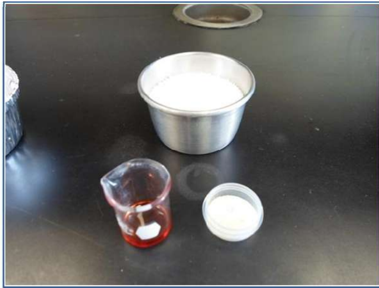
Figura 4-6. Materiales con los cuales se modificó el asfalto: polímero SBS, resina fenólica y azufre.
