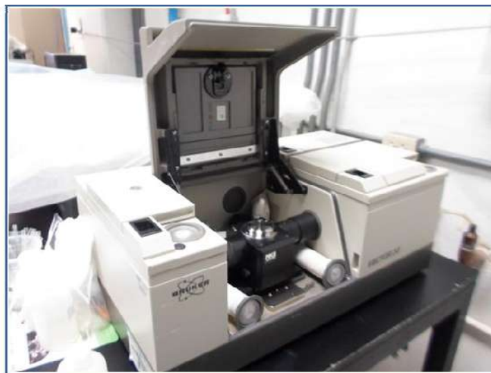
Figura 4-20. Colocación de la película de la muestra en el cristal de diamante del espectrofotómetro.
