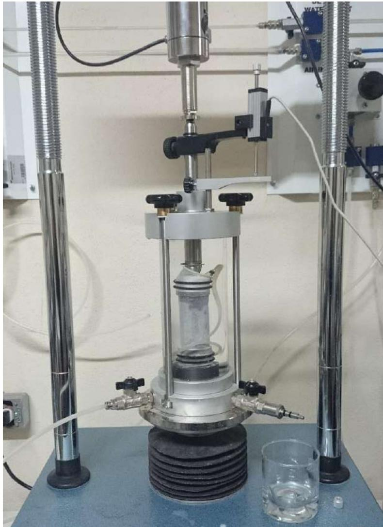
*Figura 3.6 Muestra montada para prueba triaxial*
