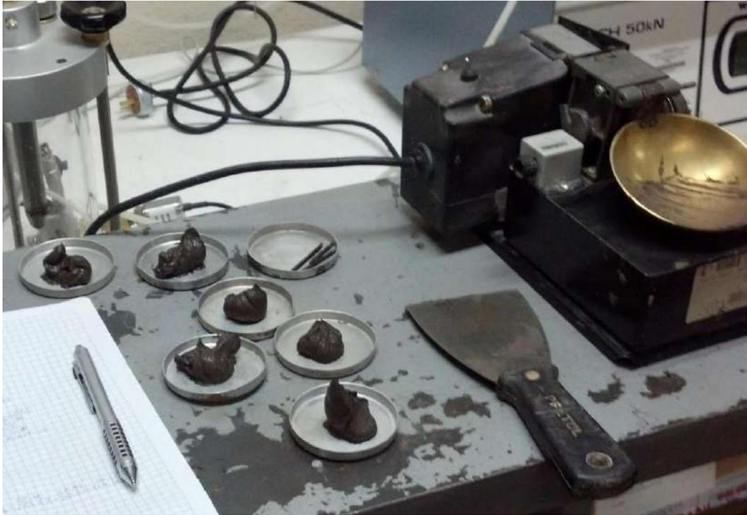
*Figura 3.5 Realización de prueba de límite líquido mediante la copa de Casagrande y límite plástico.*
