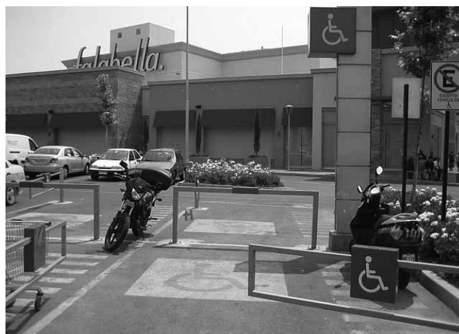
Figura 112. Estacionamiento de buenas dimensiones. La barrera dificulta estacionarse si no hay un guardia disponible. Accesible.net 2008
