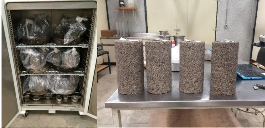
**Figura 3.36** Proceso de curado de los especímenes.
