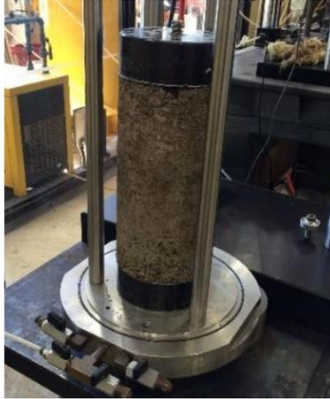
**Figura 3.42** Colocación de Probeta sobre la piedra porosa.
