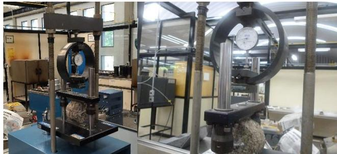
**Paso 3.** Aplique la carga al espécimen, de forma gradual, a una velocidad de carga de 50.8mm por minuto hasta alcanzar la carga máxima.
