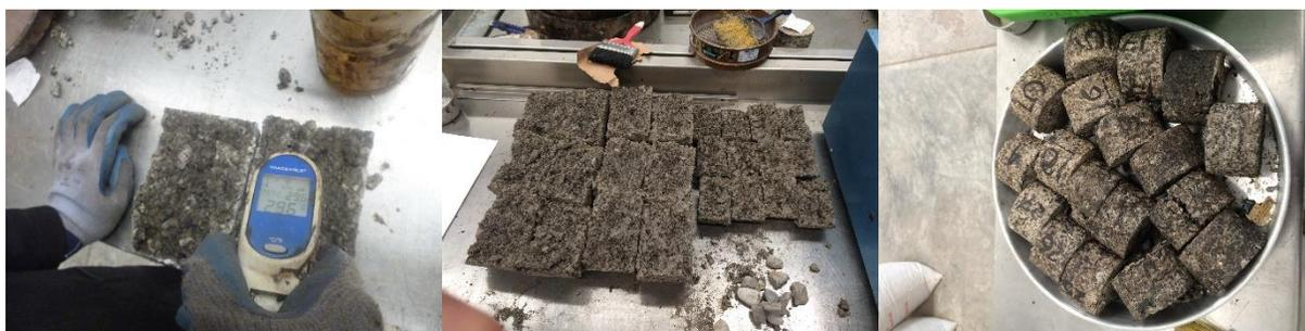
**Paso 7.** Tome una muestra a partir de los especímenes NO sumergidos en agua para determinar el contenido de agua al momento de la falla. Determine el contenido de humedad del espécimen mediante la ecuación 11:
