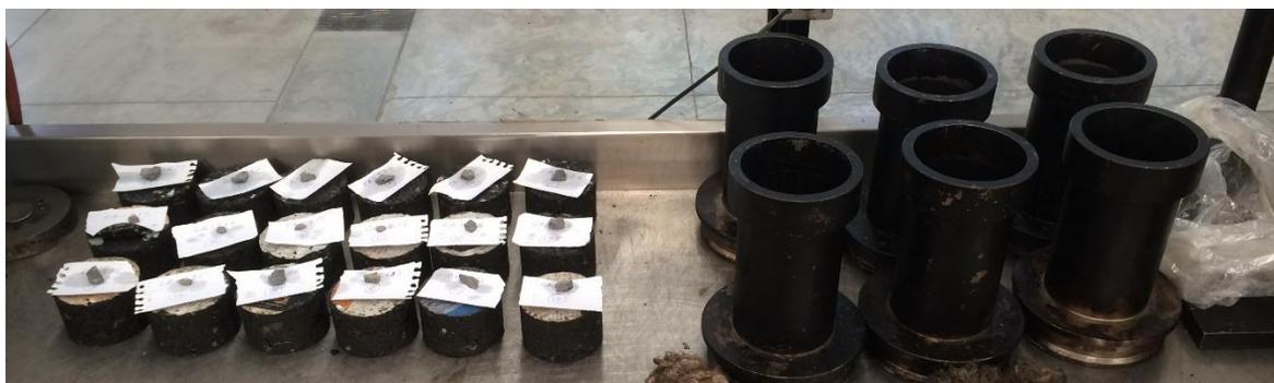
**Figura 3.21** Especímenes Nivel I Compactados Mediante el Compactador Giratorio.
