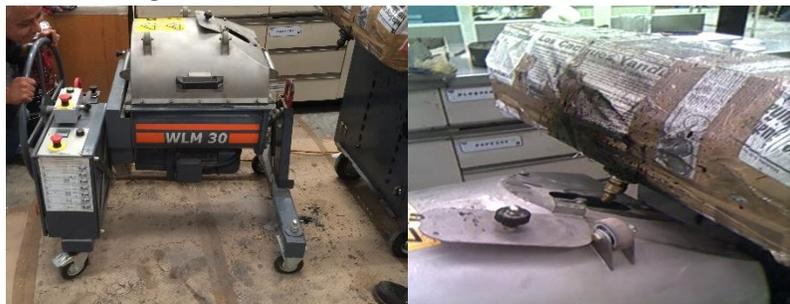
**Paso 9.** Encienda el mezclador y deje que se mezcle por al menos 10 segundos antes de descargar la masa requerida de asfalto espumado en la cámara de mezclado. Aplique la descarga de asfalto espumado Después de que el asfalto espumado ha sido descargado en el mezclador, continúe mezclando por 30 segundos más, o hasta que se haya mezclado uniformemente.
