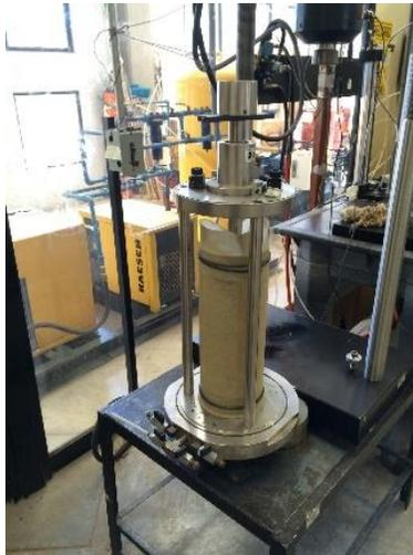
**Figura 3.43** Colocación de Membrana de látex.
