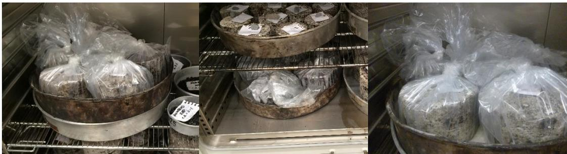
Retire los especímenes del horno después de las 48 horas y saque las muestras de sus respectivas bolsas, asegurando que la humedad dentro de las bolsas no entre en contacto con el espécimen. Permita enfriar los especímenes a 25°C ( $\pm 2.0^\circ\text{C}$ ).
