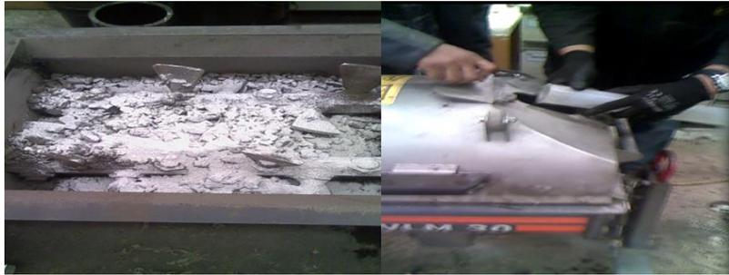
**Paso 5.** Mezcle el material, el relleno activo y el agua en la mezcladora hasta que sea uniforme.
