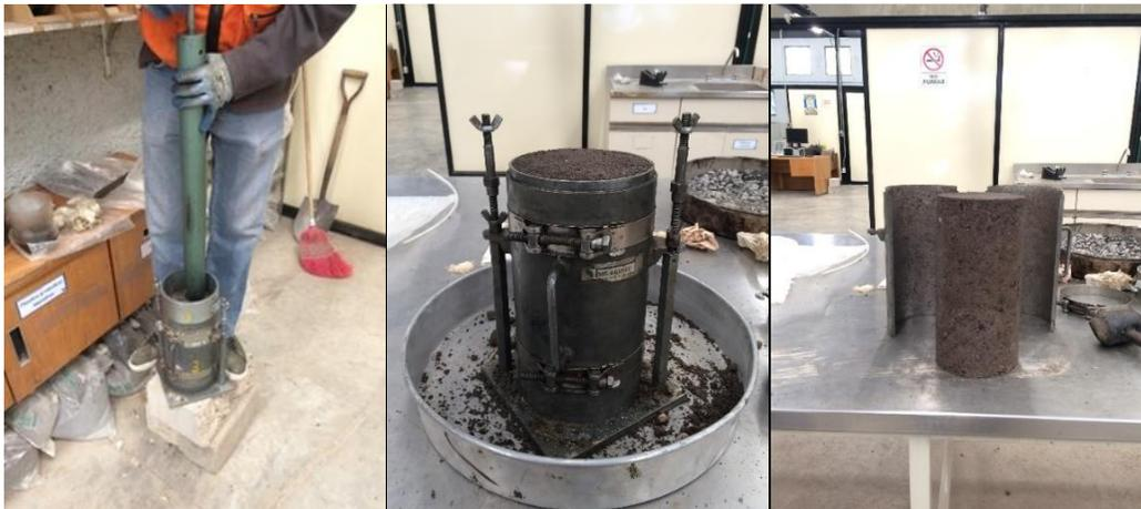
**Figura 3.34** Compactación, Enrasado y desacoplamiento del molde.
