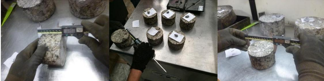
**Figura 3.24** Mediciones de especímenes para ITS.
