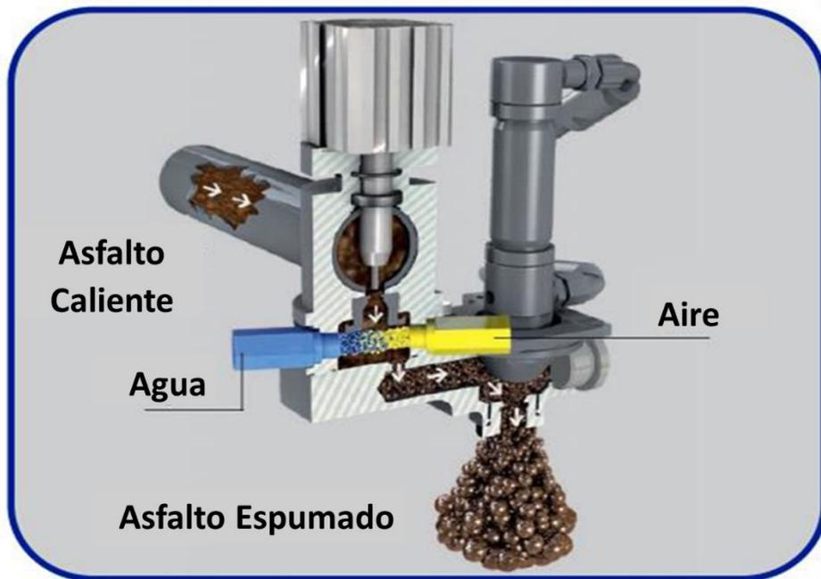
**Figura 2.3** Cámara de Expansión para asfalto espumado (Ovalle, 2015).
