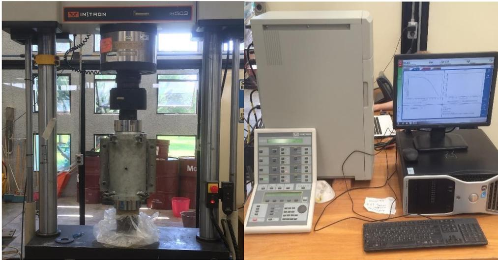
**Figura 3.39** Montaje e Inicialización de la Prueba triaxial.
