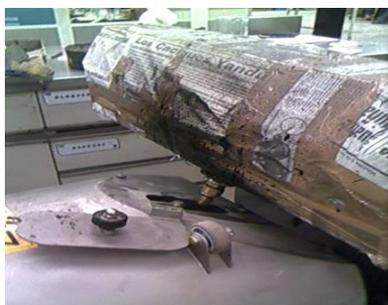
**Paso 12.** Libere la palanca para poder descargar el material tratado con asfalto espumado, realice la homogenización y cuarteos del mismo, transfiera a un recipiente hermético y selle inmediatamente para retener la humedad. Para minimizar la pérdida de humedad de las muestras, elabore los especímenes
