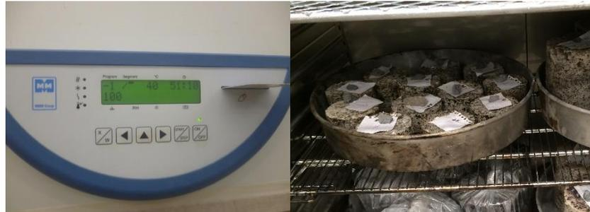
Cuando se ha logrado la masa constante, retire los especímenes del horno y permita enfriar los especímenes a 25°C ( $\pm 2.0^\circ\text{C}$ ).
