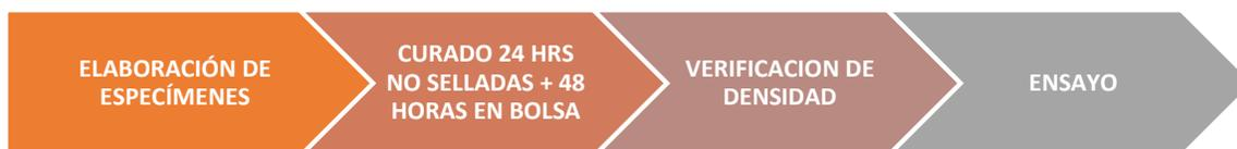
**Figura 3.31** Procedimiento de acondicionamiento para ensayo de Especímenes Nivel III.
