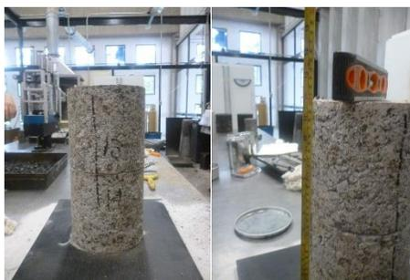
**NOTA:** El ensayo de los especímenes de prueba triaxial deberá ser planificada entre 48-72 hrs. Después del procedimiento de curado.
