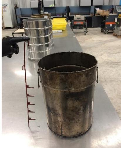
**Figura 3.14** Recipiente y varilla estandarizada para Medición de Expansión de asfalto espumado.
