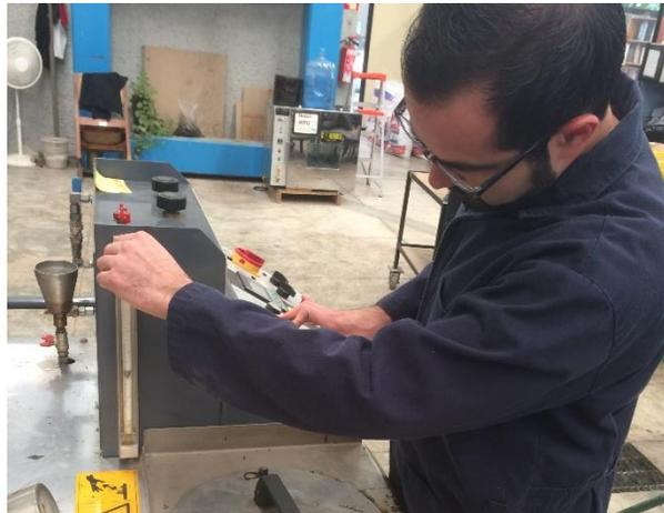
**Figura 3.16** Ajuste del Fluxómetro en el equipo WLB-30S
