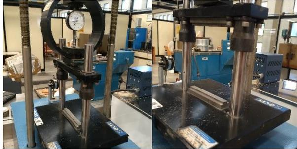
**Paso 2.** Coloque la placa de transferencia de carga en la banda de soporte superior y posicione la plantilla de soporte centrada bajo el dispositivo medidor de carga de ensayo de compresión.
