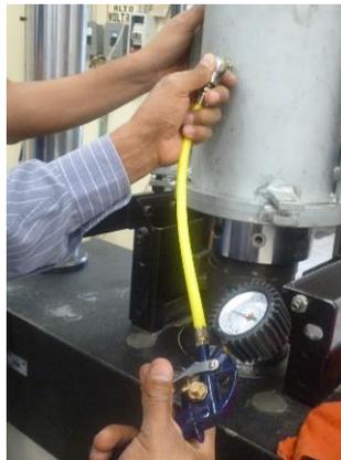
**Figura 3.38** Regulación de la presión de confinamiento en la membrana.
