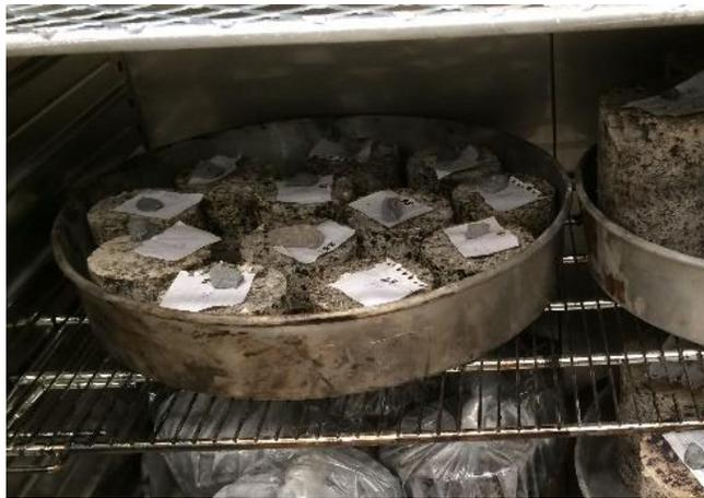
**Figura 3.22** Especímenes  $ITS_{SECO}$ .
