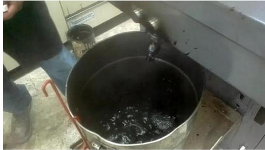
**Paso 6.** Use el cronómetro para medir el tiempo en segundos que le toma a la espuma reducirse a la mitad de su volumen máximo. Esto es tomado como la vida media del asfalto espumado.
