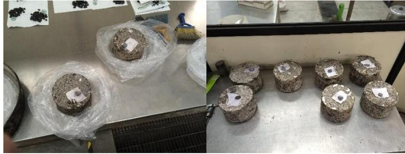
**Nota:** Si la elaboración de las probetas fueron requeridos papel filtro, cuidar de que los mismos sean retirados lo antes posible, ya sea antes de ingresar las probetas al horno o después de lograr la masa constante, procurando no dañar los especímenes.
