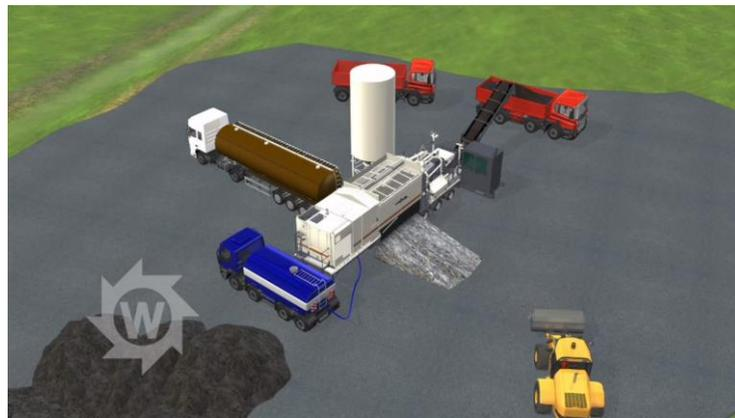
**Figura 2.10** Reciclado en Frío en Planta con Asfalto Espumado con el Equipo KMA-220. Fuente: Wirtgen (2015).
