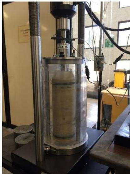
**Figura 3.45** Ensamblaje final sobre el marco de carga.
