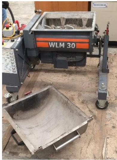
**Figura 3.19** Equipo Mezclador de Doble Eje Wirtgen WLM-30.
