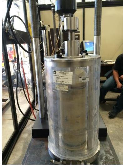
**Figura 3.44** Colocación de cámara de acrílico.
