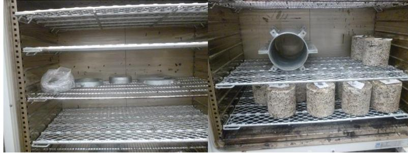
**Paso 2.** Extraiga los elementos de la carcasa de la cámara de climatización, engrase ligeramente los lados del disco así como la base de la placa superior, esto con el propósito de reducir la fricción que pudieran generar dichos elementos.
