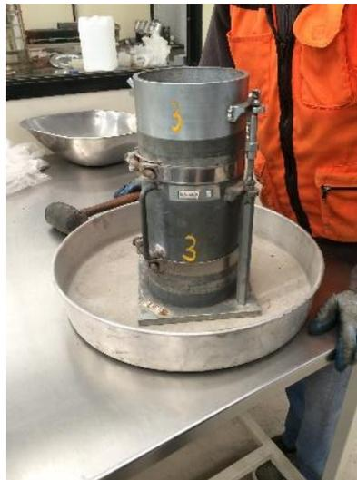
**Figura 3.33** Molde para elaboración de especímenes
