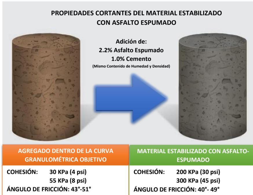
**Figura 2.8** Propiedades cortantes de los materiales estabilizados con Asfalto Espumado.
