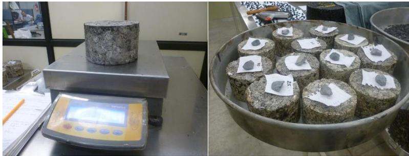
**Paso 2.** Mida la altura del espécimen en cuatro puntos separados alrededor de la circunferencia y calcule una altura promedio (h).
