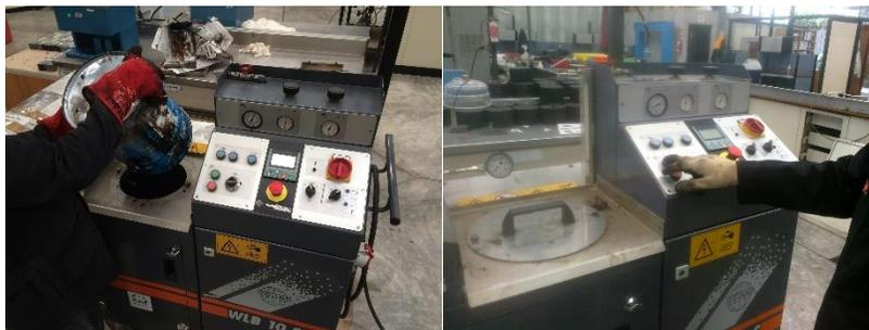
**Paso 2.** Ajustar la velocidad de descarga del asfalto y ajustar el temporizador en el Wirtgen WLB10 S para descargar 500g de asfalto ( $Q_{asfalto}$ )
