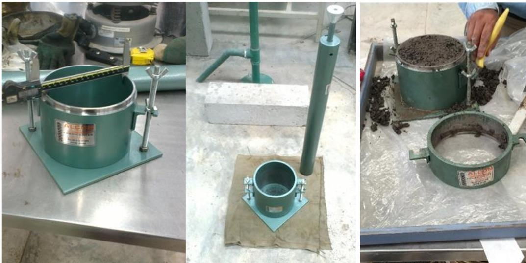
**Figura 3.11** Molde para variante tipo "D"
