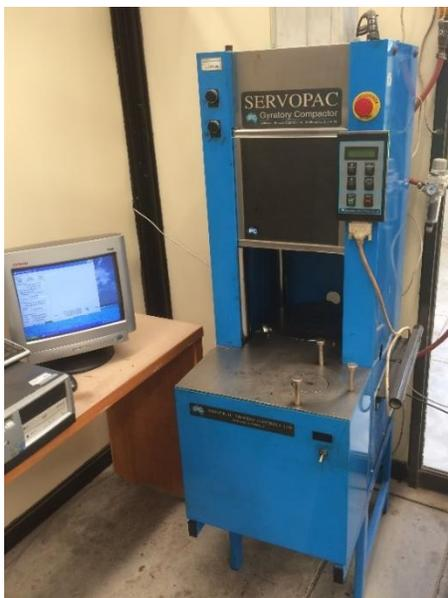
**Figura 3.20** Compactador Giratorio SERVOPAC. Propiedad del IMT.
