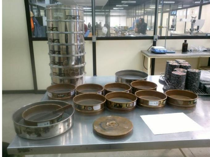
**Figura 3.9** Tamices y Mallas para el ensayo Granulométrico.
