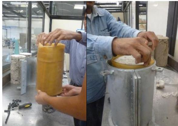
**Figura 3.37** Colocación de la Membrana de Látex en el espécimen triaxial.
