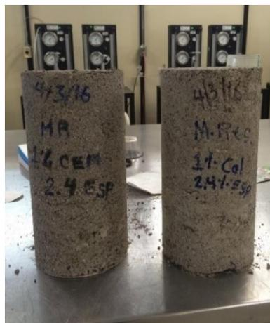
**Figura 3.47** Especímenes ensayados para obtención de  $M_R$ .
