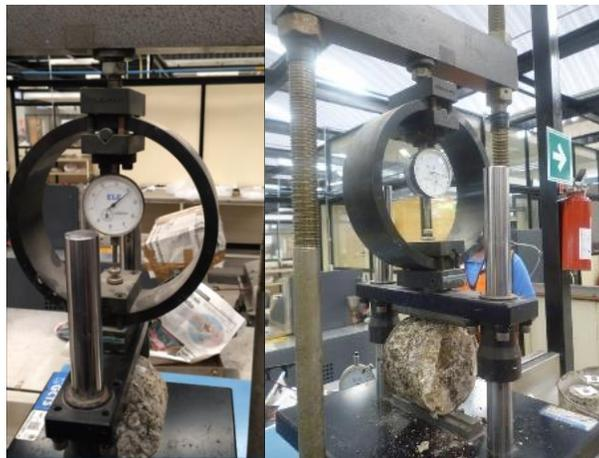
**Figura 3.25** Ensayo de pruebas ITS.
