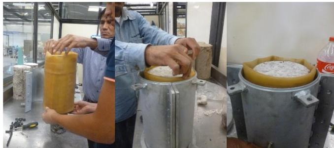
**Paso 5.** Asegure la carcasa, mediante las abrazaderas y/o tornillos de sujeción.
