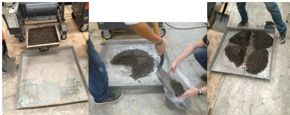
Repita los pasos de arriba para al menos cuatro mezclas con diferente contenido de asfalto espumado, con intervalos de 0.2% de asfalto. A continuación se presenta una guía para estimar la adición óptima de asfalto espumado, según las características del material.
