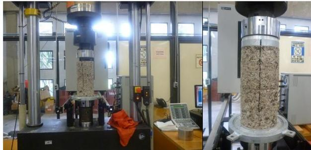
**Paso 4.** Introduzca cuidadosamente la carcasa, comprimiendo la cámara de látex alrededor del espécimen. Procure no dañar los bordes de la muestra durante el procedimiento.
