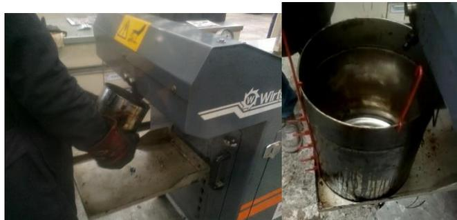
**Paso 5.** Usando la varilla de medición suministrada con la Wirtgen WLB10S (la cual esta calibrada para un recipiente de acero de 275mm de diámetro y 500g de asfalto) mida la altura máxima del asfalto en el recipiente. Esto se toma como el volumen máximo.
