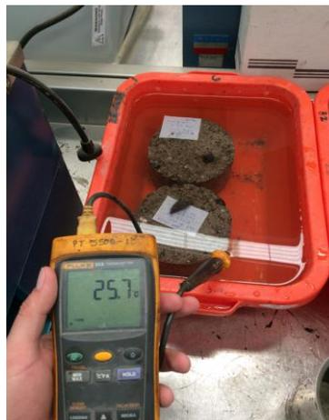
**Figura 3.23** Especímenes  $ITS_{SATURADO}$ .
