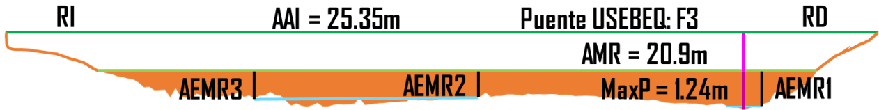
Figura 22. Perfil geomorfológico del sitio Puente USEBEQ.
