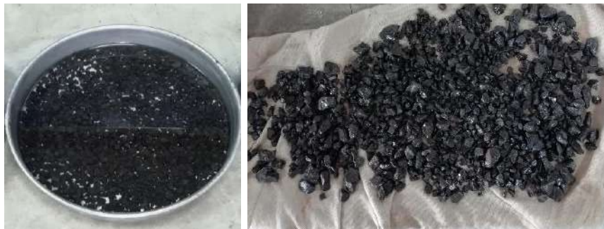
Figura 3- 12: Desarrollo de la prueba de densidad y absorción en la grava y el sello. Fuente: imagen capturada por el autor.
