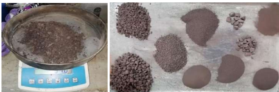
Figura 3- 26: Agregado reciclado sin asfalto y separado por tamices. Fuente: imagen capturada por el autor.
