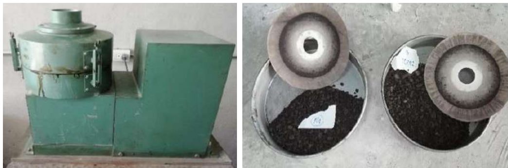
Figura 3- 25: Equipo “Rotarex” y muestras después de la remoción de asfalto. Fuente: imagen capturada por el autor.
