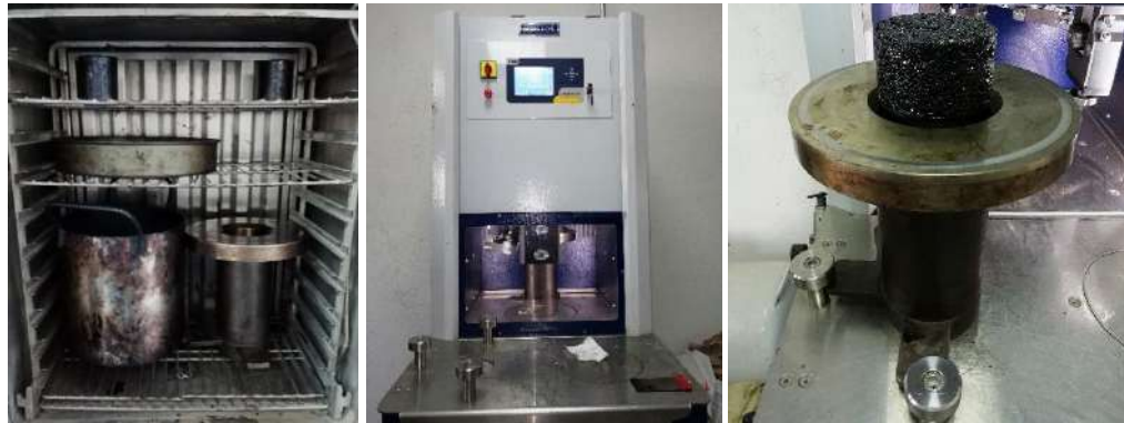
Figura 3- 38: Equipo utilizado durante el proceso de compactación giratoria.
