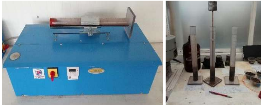
Figura 3- 9: Desarrollo de la prueba de equivalente de arena.
