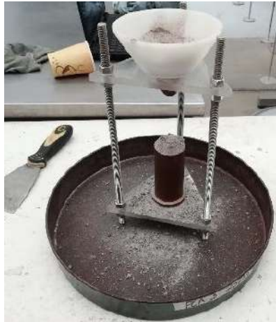
Figura 3- 10: Desarrollo de la prueba de angularidad en la parte fina.
