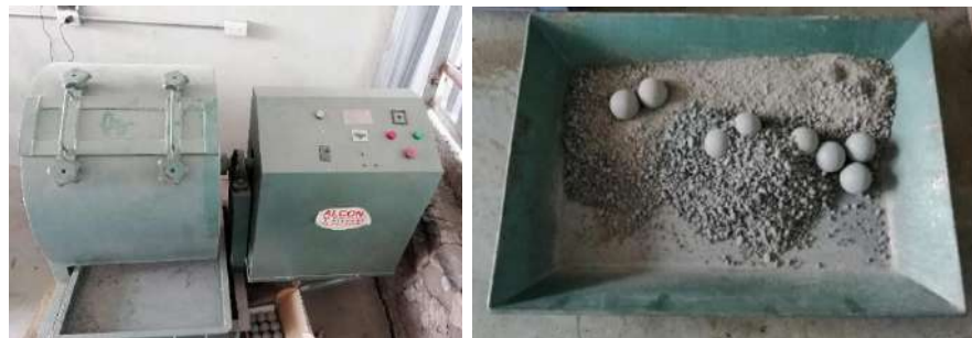
Figura 3- 3: Máquina de los ángeles y esferas de acero utilizadas.
