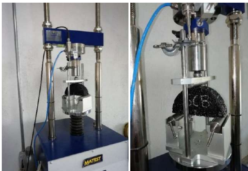
Figura 3- 44: Prensa, marco de carga y accesorios utilizados en las pruebas de energía de fractura.
