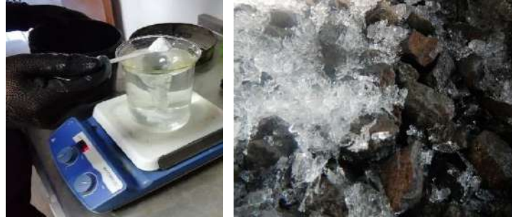
Figura 3- 5: Cristales formados durante la prueba de intemperismo acelerado.
