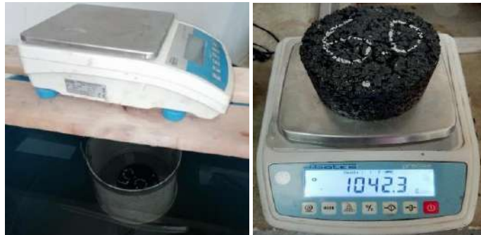
Figura 3- 40: Equipo utilizado en el ensayo gravedad específica bruta de especímenes compactados ( G_{mb} ).
