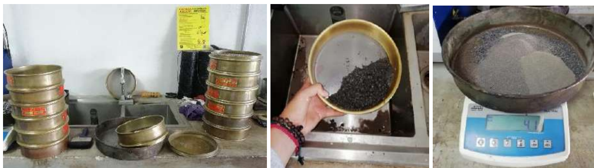
Figura 3- 14: Equipo empleado en el análisis granulométrico.
