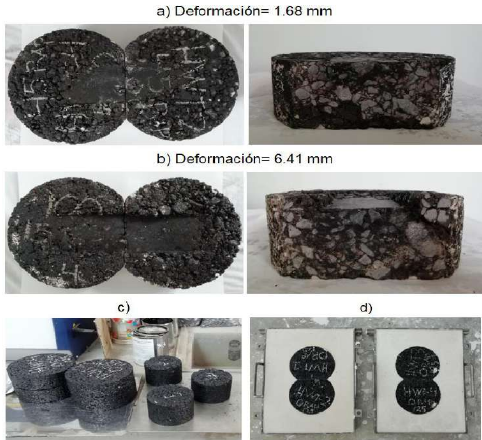
Figura 4- 27: Ejemplo de probetas destruidas en la Rueda Cargada de Hamburgo. Fuente: elaboración propia.
