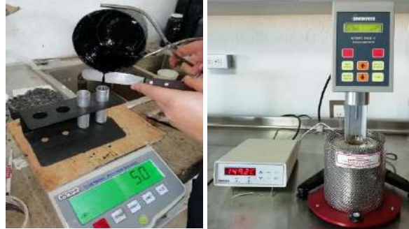
Figura 3- 23: Equipo utilizado para determinar la viscosidad Brookfield.
