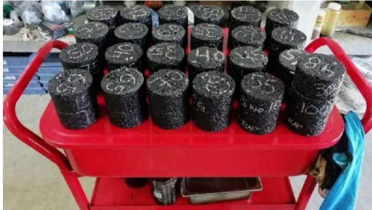
Figura 4- 16: Probetas fabricadas durante la etapa del diseño volumétrico (altura= 63.0 milímetros y diámetro= 100 milímetros).
