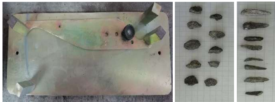
Figura 3- 7: Equipo utilizado y ejemplo de partículas planas y alargadas.
