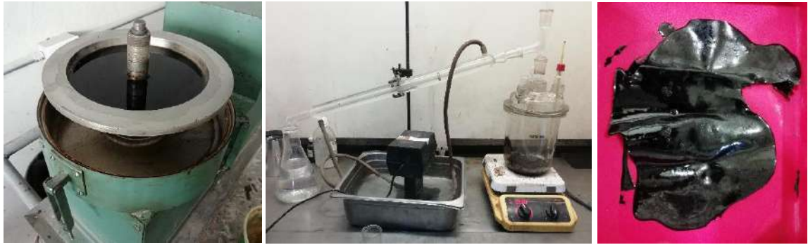
Figura 3- 28: Extracción y recuperación del asfalto envejecido presente en el pavimento asfáltico recuperado (RAP).
