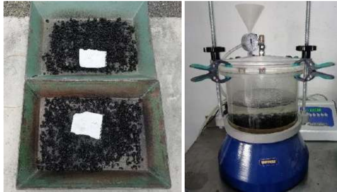
Figura 3- 39: Equipo utilizado en el ensayo gravedad específica teórica máxima de la mezcla suelta ( G_{mm} ).
