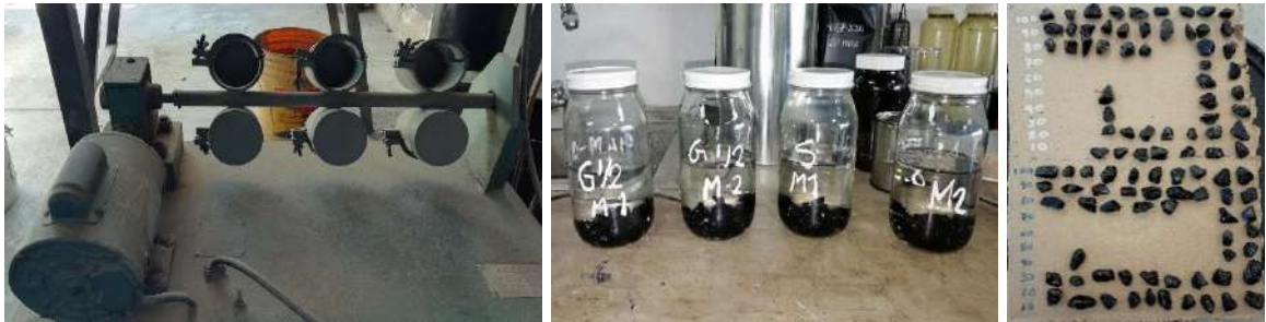
Figura 3- 8: Desarrollo de la prueba de desprendimiento por fricción.
