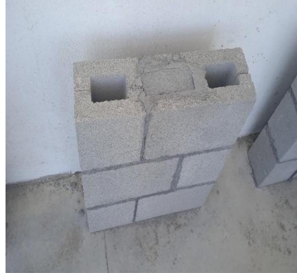
**Figura 33. Murete fabricado con block hueco open-end.**
