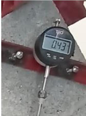
Figura 59. Desplazamiento de murete construido con piezas open-end.
