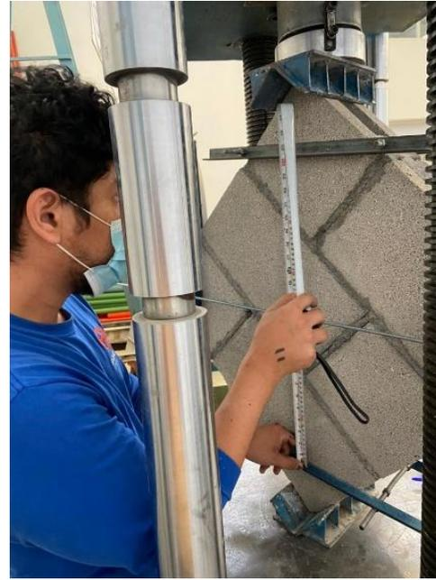
**Figura 36. Preparación de murete para ensaye en la máquina universal.**
