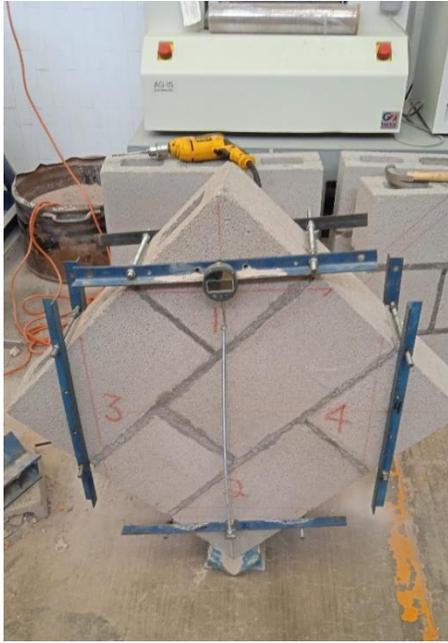
**Figura 35. Colocación de micrómetros en las diagonales de los muretes.**
