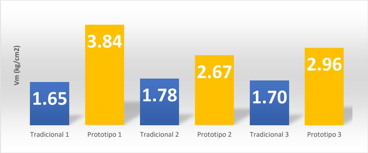
Figura 52. Comparación de la resistencia a compresión diagonal, primera experimentación.
