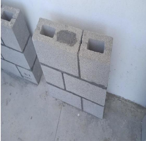
**Figura 32. Murete testigo fabricado con block hueco tradicional.**
