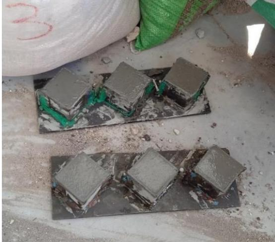
**Figura 27. Especímenes de mortero.**
