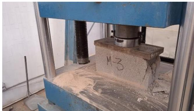
**Figura 26. Ensaye de compresión en piezas de mampostería.**
