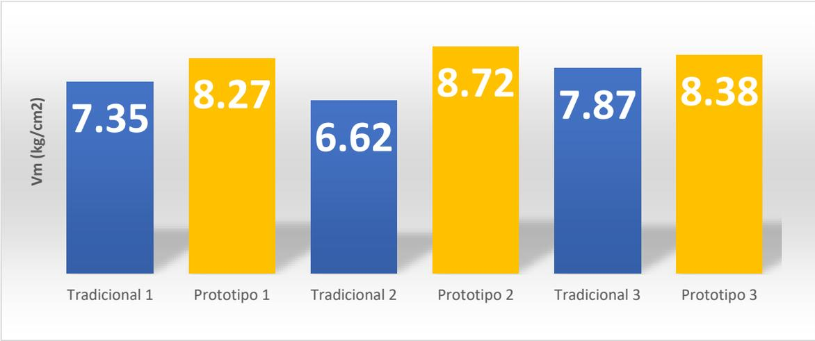
Figura 54. Comparación de la resistencia a compresión diagonal, segunda experimentación.
