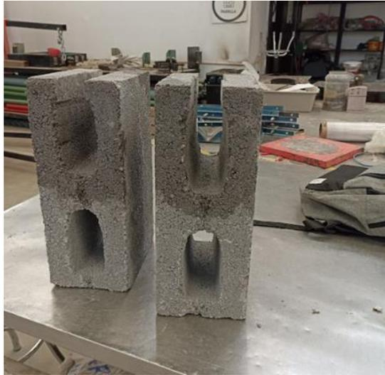
**Figura 29. Piezas huecas con un extremo recortado.**
