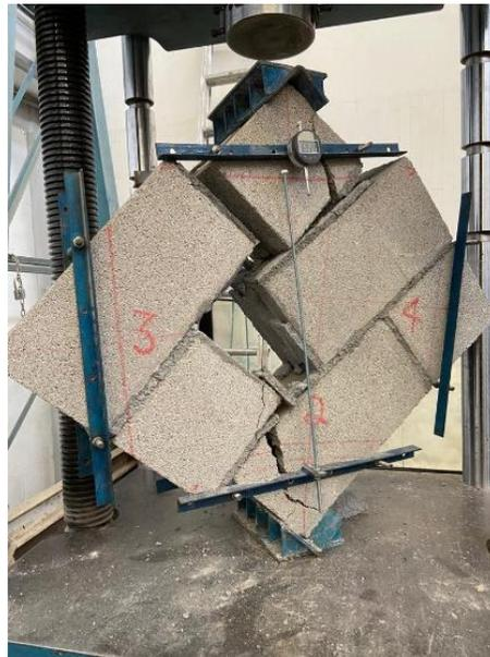
**Figura 37. Ensaye de compresión diagonal en murete de mampostería.**
