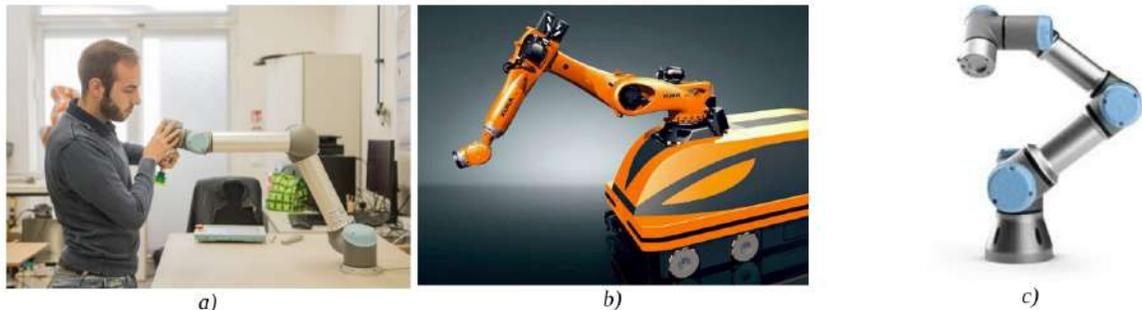
Figura 1.1: a) Robot guiado manualmente por el usuario (Universal Robots UR5), b) Brazo robot con plataforma móvil Kuka Mobile Robotics (KMR) Quantec.
