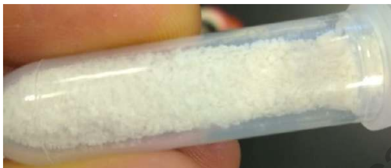
Figura 5.3 Muestra de HAp sintetizada mediante el método hidrotermal asistido por microondas
