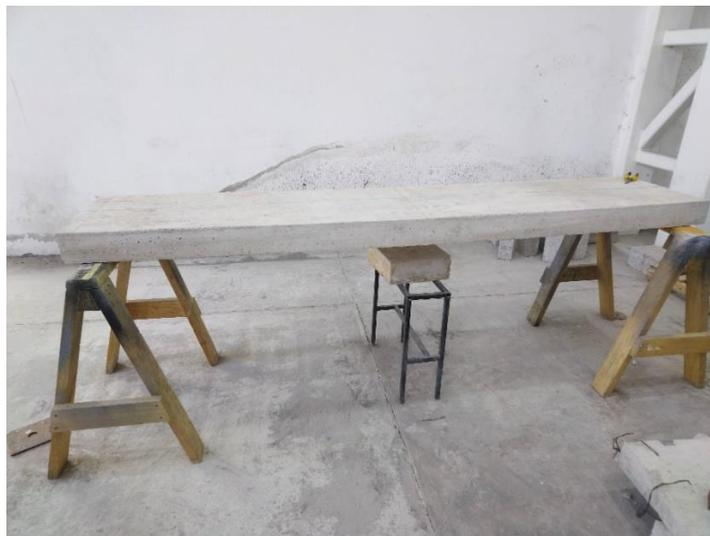
**Figura 4.41** Carga perpendicular al plano sobre la probeta de ensaye
