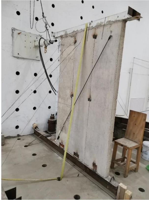
**Figura 4.30** Colocación de eslinga para ejercer carga de compresión sobre la probeta de ensaye
