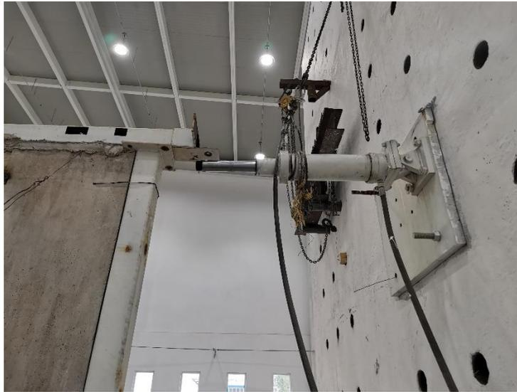
**Figura 4.32** *Gato hidráulico para ejercer fuerza lateral sobre la probeta de ensaye*
