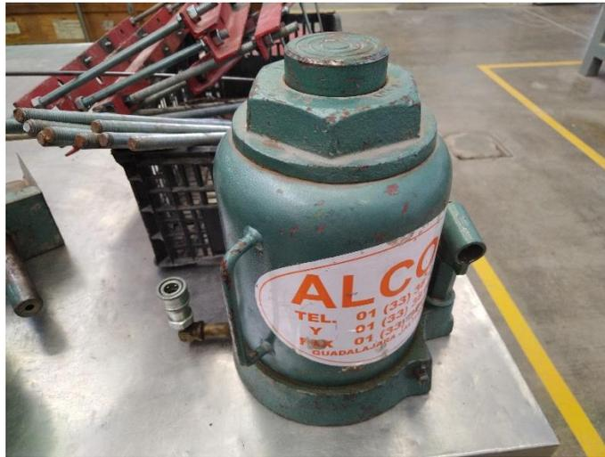
*Figura 4.23 Gato hidráulico con capacidad de 30 ton*
