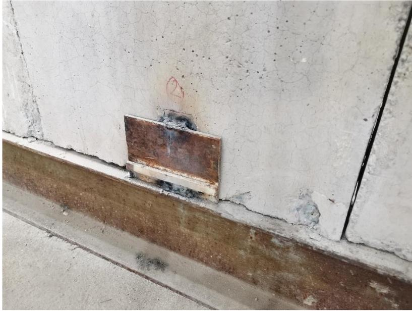
**Figura 4.27** *Conexión de cimentación del panel para prueba de carga lateral*
