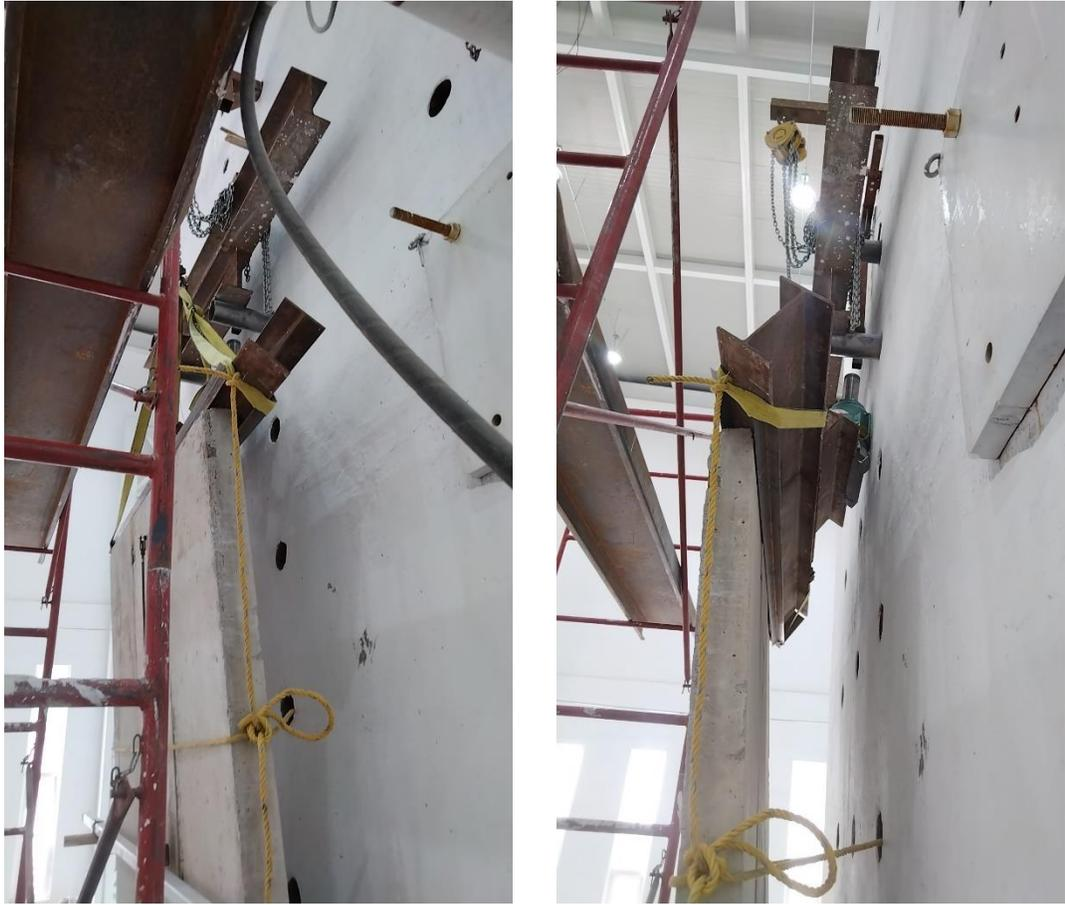
**Figura 5.10** *Falla a compresión del muro panel modular*
