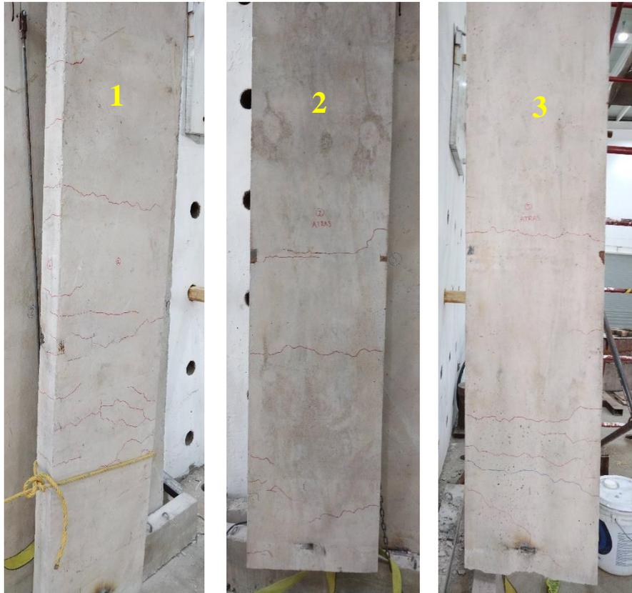
**Figura 5.12** *Agrietamiento posterior del MPM sometido a compresión*
