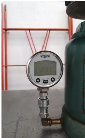
*Figura 4.24 Manómetro para registrar la presión ejercida por el gato hidráulico*
