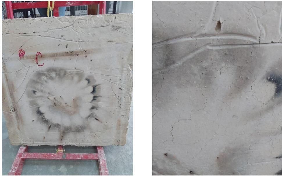
**Figura 5.21** *Agrietamiento de probeta sometida a fuego directo*
