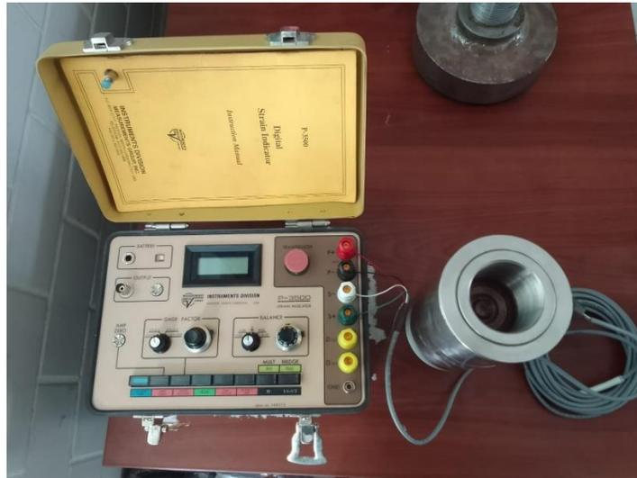
**Figura 4.33** Celda de carga e instrumento de lectura
