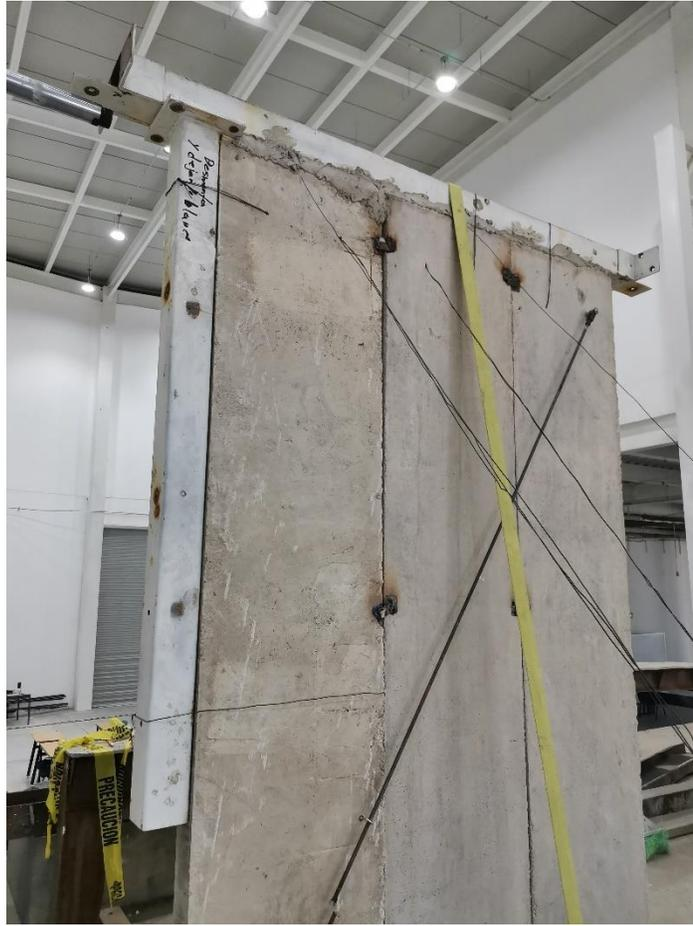
**Figura 4.29** *Perfiles de acero para la distribución de cargas en prueba de carga lateral*
