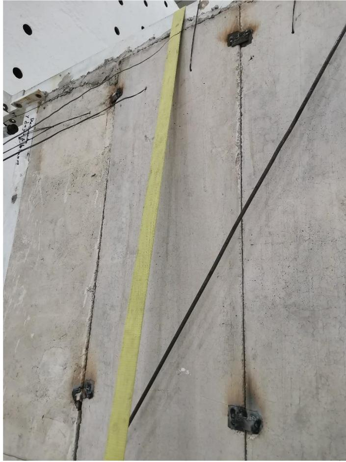
**Figura 4.28** *Conexión soldada del MPM para prueba de carga lateral*
