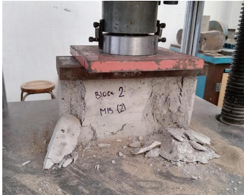
**Figura 5.1** *Ensayo de compresión a block de concreto ligero*
