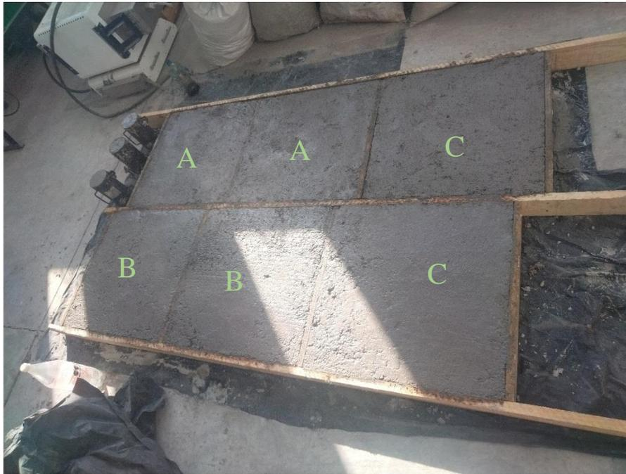
**Figura 4.36** *Especímenes para prueba de fuego*
