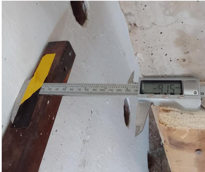
**Figura 4.39** Sistema de medición para la deformación presentada en la prueba de impacto
