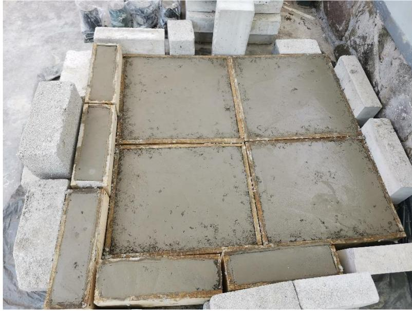
**Figura 4.17** *Pieza, pila y murete de una mezcla de concreto ligero*
