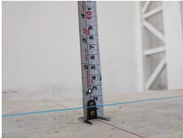
**Figura 5.28** Deformación inicial del elemento sometido a carga perpendicular al plano
