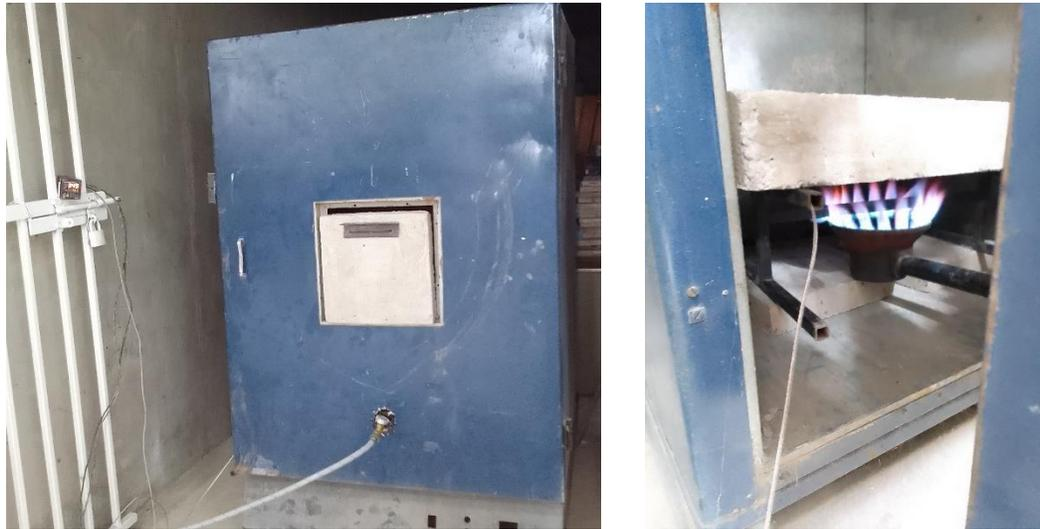
**Figura 4.35** Adaptación de horno a cámara de fuego
