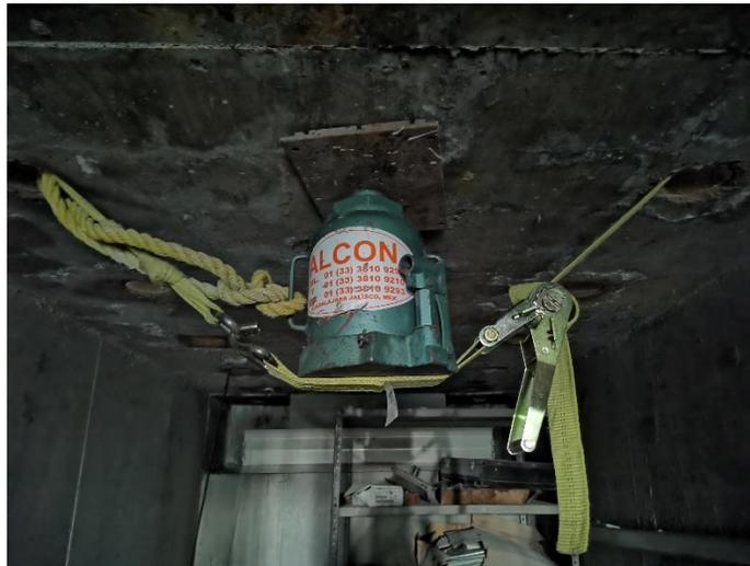
**Figura 4.31** Colocación de gato hidráulica para ejercer una carga de compresión de la probeta de ensaye
