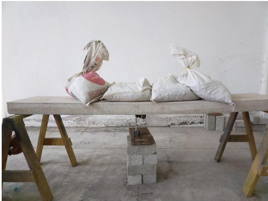
**Figura 4.42** *Carga perpendicular al plano sobre el MPM*
