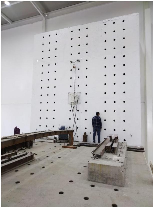
**Figura 4.19** Muro de reacción de la Universidad Autónoma de Querétaro
