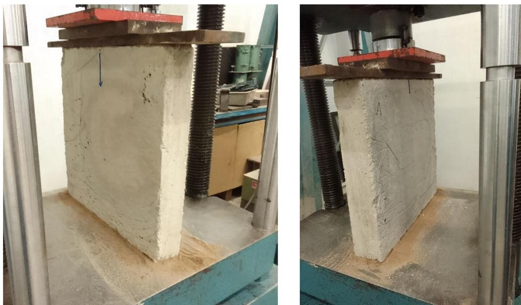
**Figura 5.22** *Ensayo a compresión de probetas testigo y sometidas a fuego*
