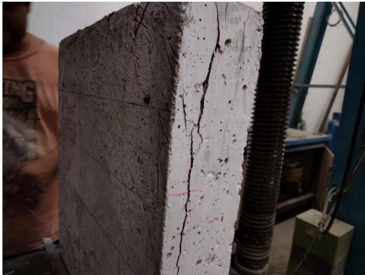
**Figura 5.5** Falla de pila con malla de refuerzo
