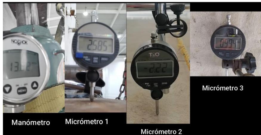
**Figura 5.13** Registro de carga y deformaciones correspondientes a la prueba de compresión
