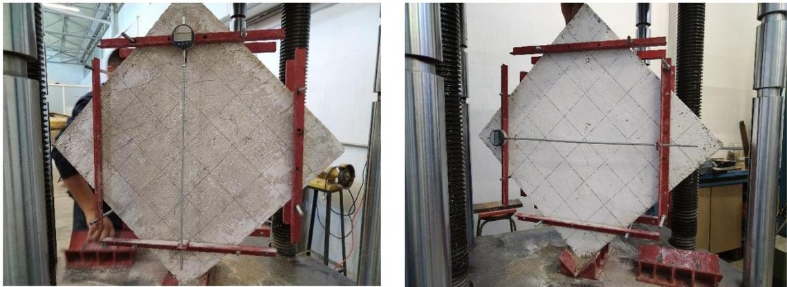
**Figura 5.6** *Ensayo de muretes de concreto ligero*
