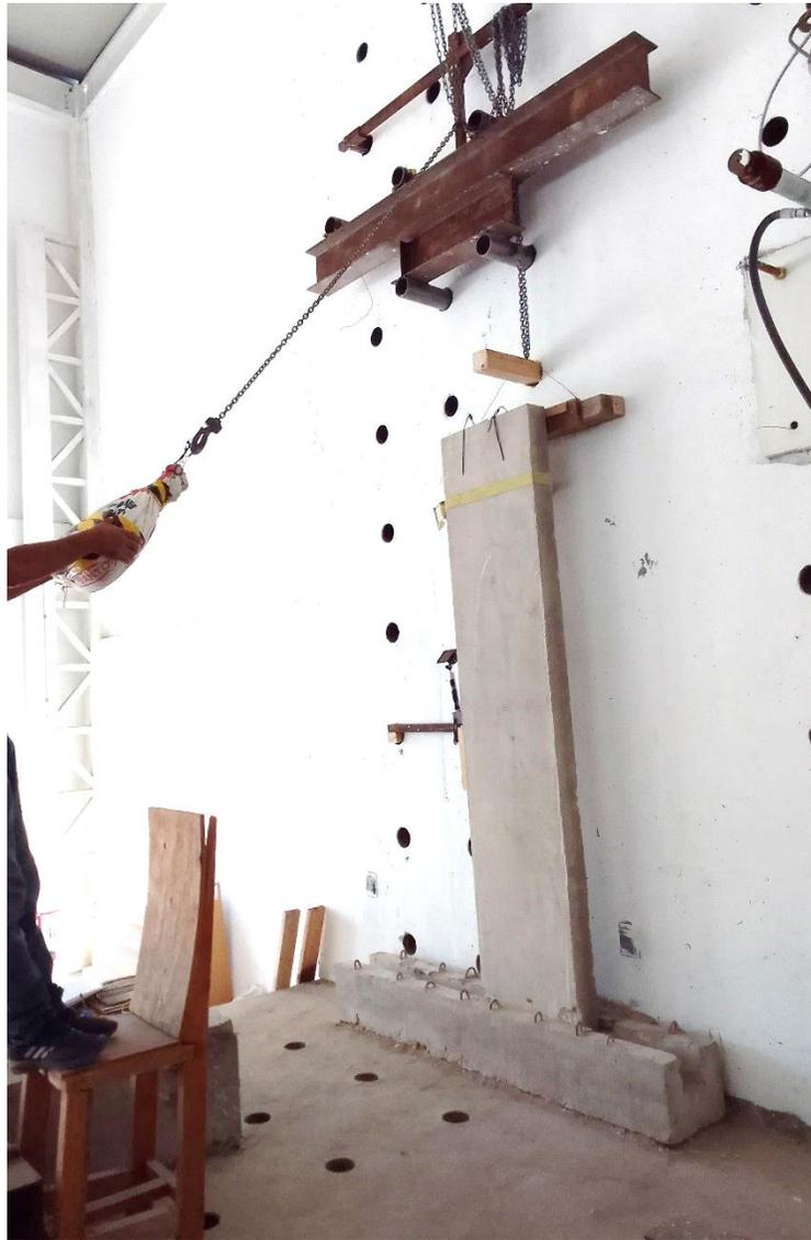
**Figura 4.38** Sistema de prueba de impacto sobre el MPM
