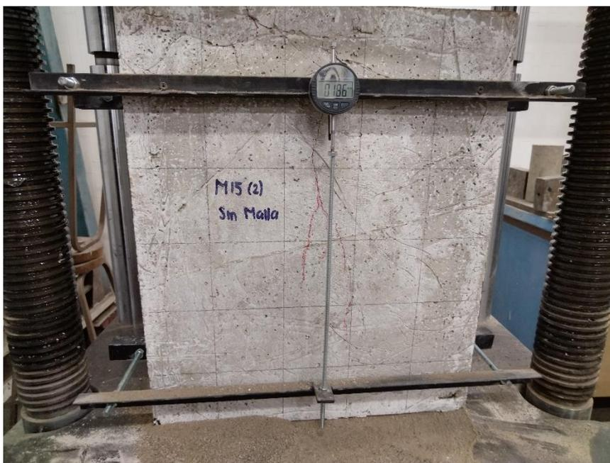
**Figura 5.2** Ensayo de pilas de concreto ligero
