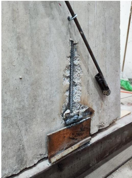
a) Desprendimiento del ancla de conexión
