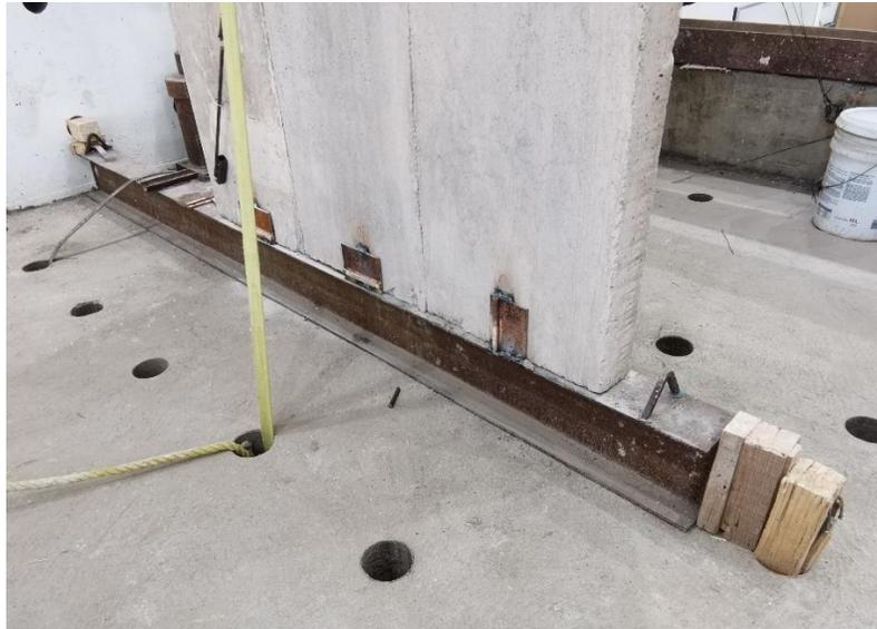
**Figura 4.26** *Cimentación para prueba de carga lateral*
