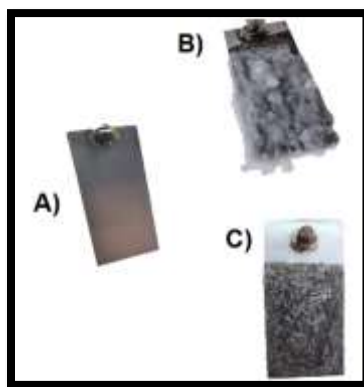
Figura 18. Diferencia entre los electrodos utilizados en una solución 0.005 \text{ mol L}^{-1} \text{ NaNH}_4\text{HPO}_4 y 1 \text{ mg L}^{-1} de \text{NaCl} a 53 \text{ mA} en a) tiempo cero, después de 6 horas de tratamiento en un sistema b) SEC y c) SEPA.
