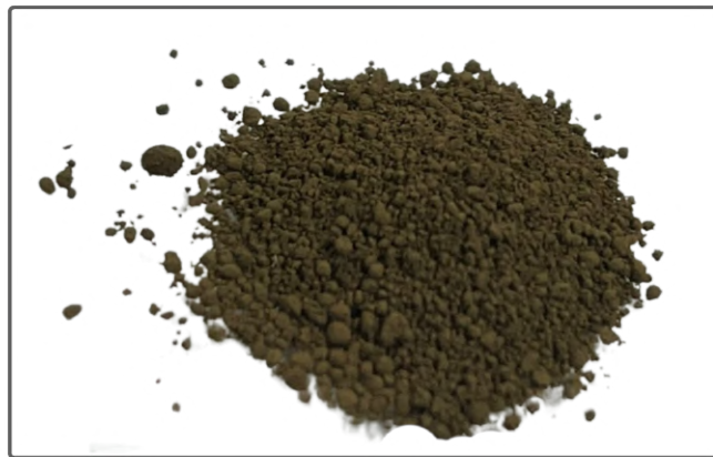
Figura 2.1: Ortoferrita de lantano en polvo después de calcinación a 800° C.
