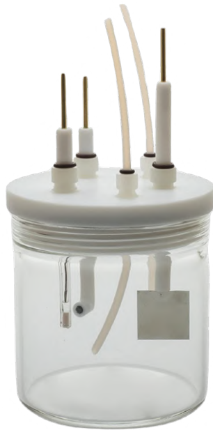
Figura 1.11: Ejemplo de celda electroquímica.
