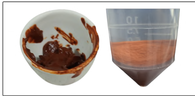
Figura 2.3: Lodo precursor de nanopartículas de ortoferrita de lantano
