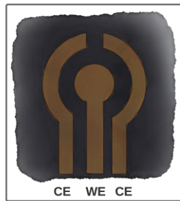
Figura 2.10: Arreglo de electrodos en chip utilizado como parte de la celda electroquímica.
