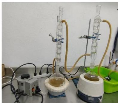
**Figura 8.** Extracción a reflujo con metanol
