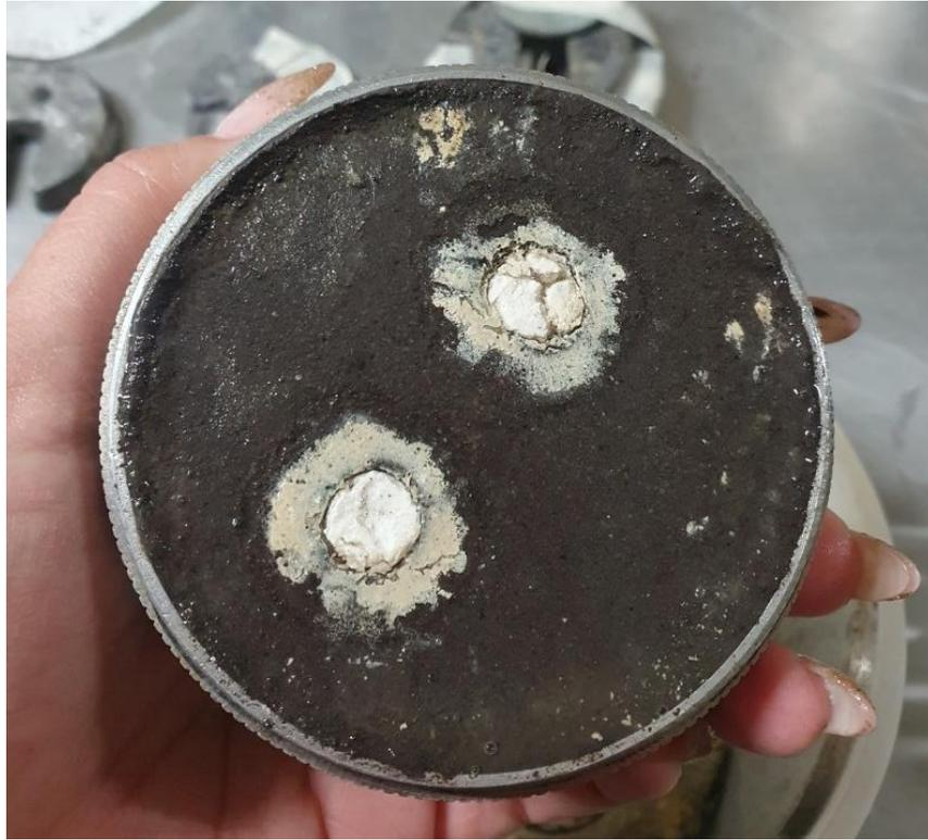
**Figura 65.** Prueba con 2 perforaciones (4% cal)
