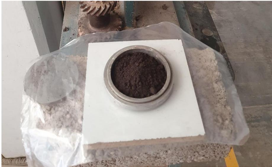
**Figura 53.** Colocación de material para hacer la pastilla
