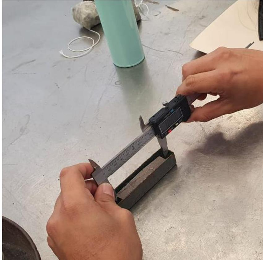
**Figura 38.** Obtención de Contracción Lineal
