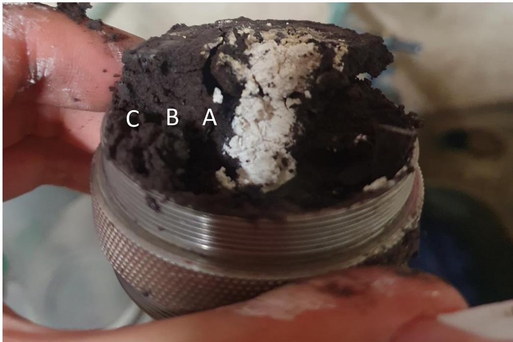
**Figura 76.** Interacción de la cal con el suelo
