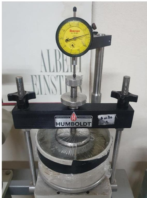
**Figura 63.** Colocación de molde en consolidómetro
