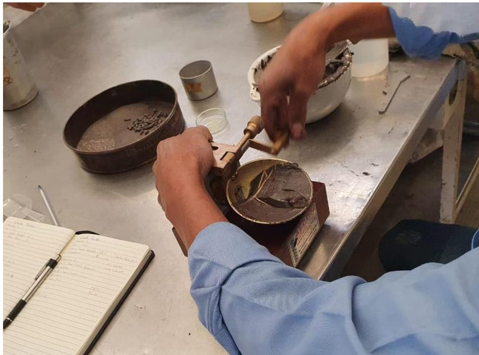
**Figura 36.** Obtención del Límite Líquido
