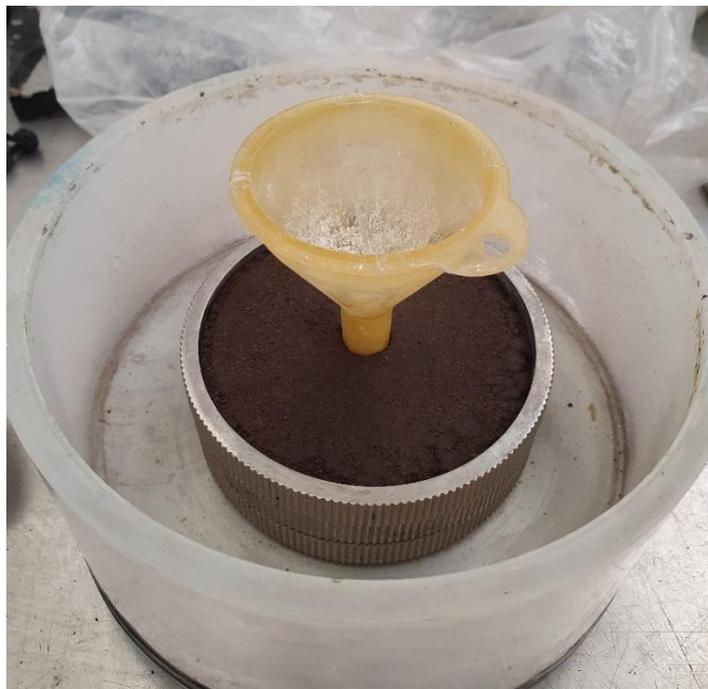
**Figura 59.** Colocación de Embudo
