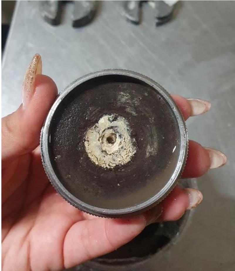
**Figura 64.** Prueba con 1 perforación (2% cal)
