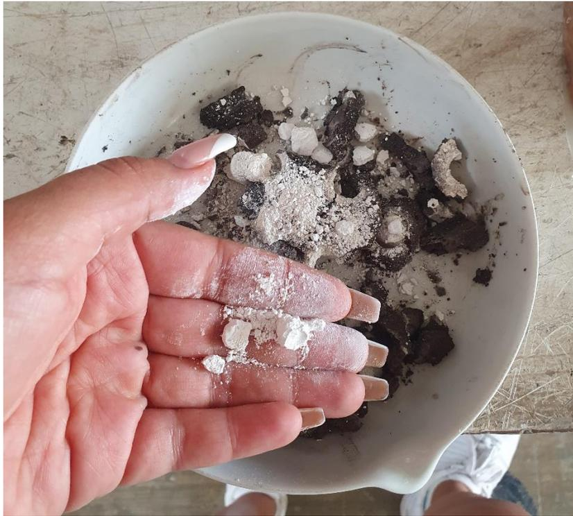
**Figura 82.** Comportamiento de la cal al secarse
