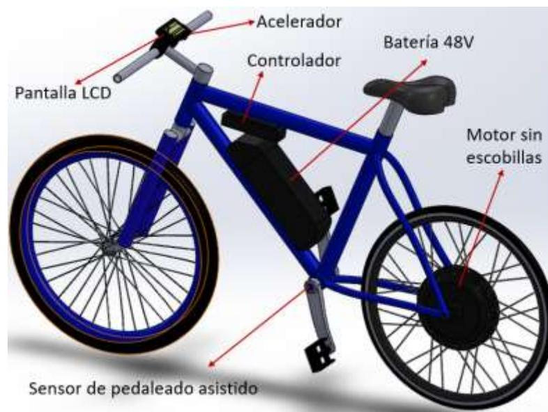
**Figura 12. Modelo CAD de la bicicleta y sistema de reconversión**
