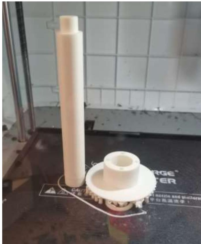
**Figura 44 Impresión del eje de rotación y soporte de balero**
