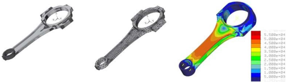
**Figura 2.- Biela discretizada para un análisis de deformaciones ( Budynas & Nisbett, 2012)**
