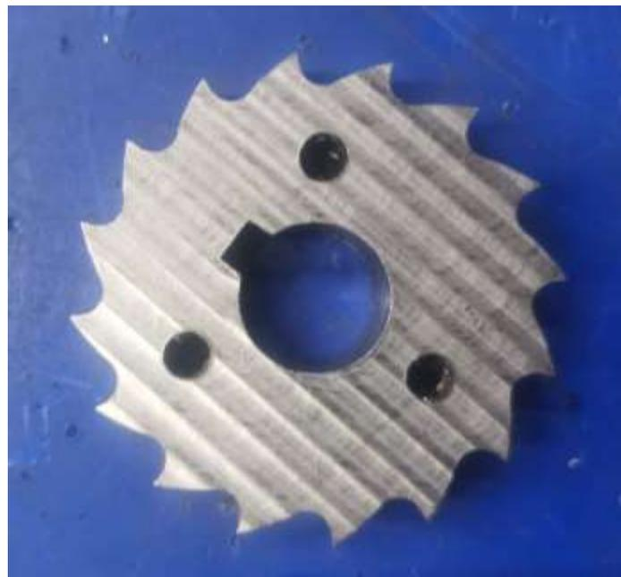
**Figura 41 Proceso de fabricación de Trinquete de salida**
