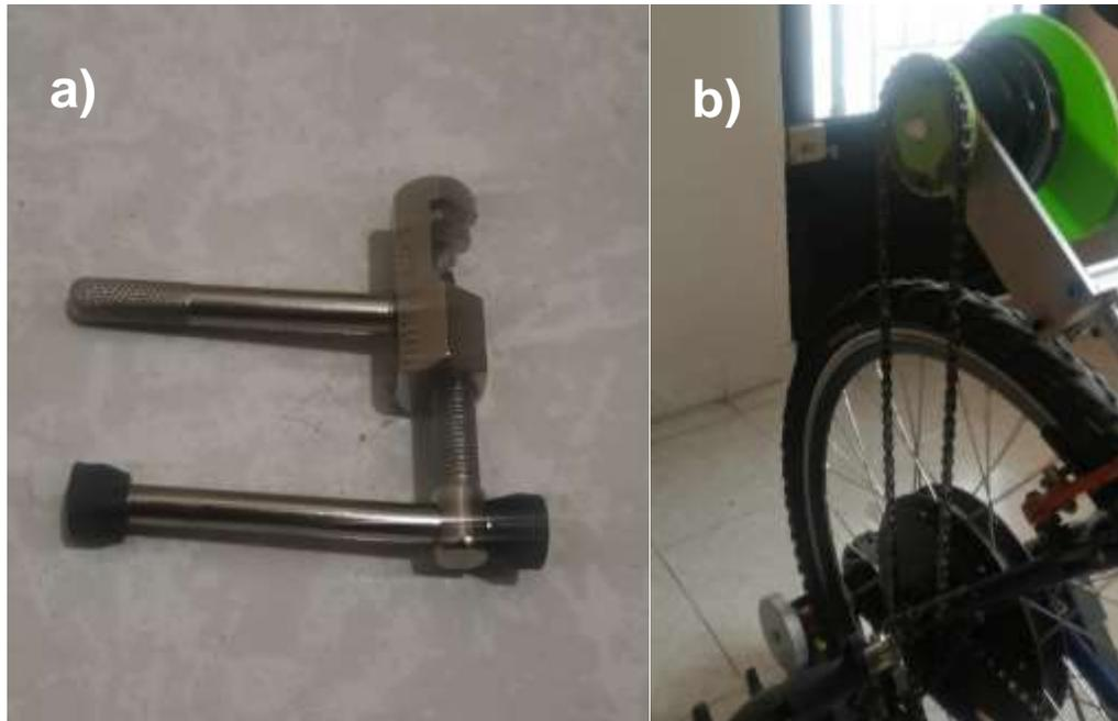
**Figura 51 KERS a) Herramienta para pernos de cadena b) Sistema montado con soportes y cadena**
