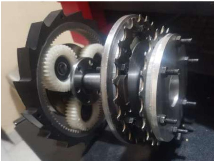
**Figura 43 Ensamble del mecanismo KERS**
