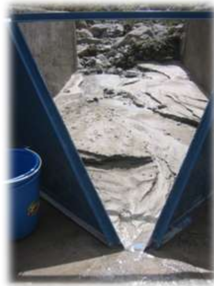
Figura 20. Estructura y dimensión del vertedor ubicado en el cauce b2 cuyas mediciones de sedimento ocurren durante el periodo de lluvias (junio-septiembre 2011).
