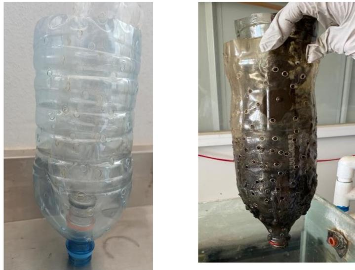
**Figura 10** Soportes de polietileno tereftalato a) acomodo en el RBLF y b) Biomasa adherida al soporte.
