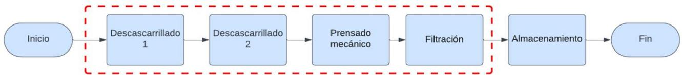
Figura 6 Extracción y procesamiento de la materia prima
