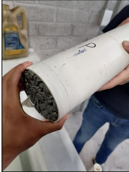
*Figura 14.- Muestra de concreto permeable con ACR colada para prueba de permeabilidad.*
