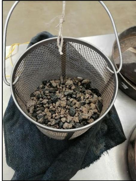
*Figura 6.-Determinación del volumen de la muestra.*
