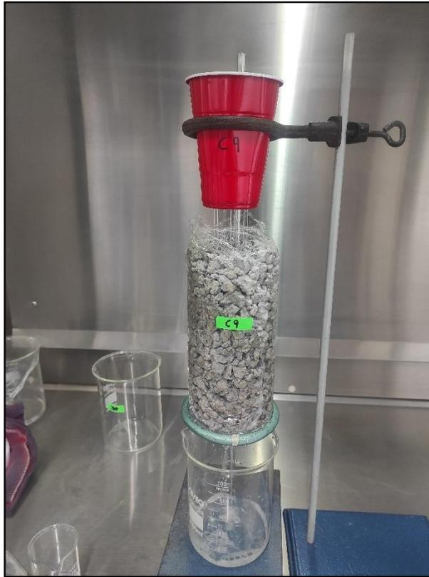
*Figura 21.- Filtrado de la solución en probetas de concreto permeable con ACR.*
