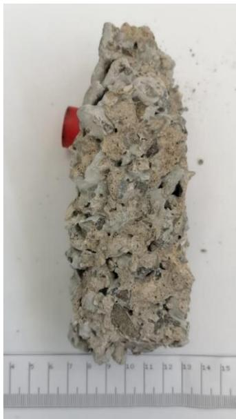
*Figura 53.- Fragmento de cilindro de concreto permeable con ACR posterior al ensayo a compresión simple.*
