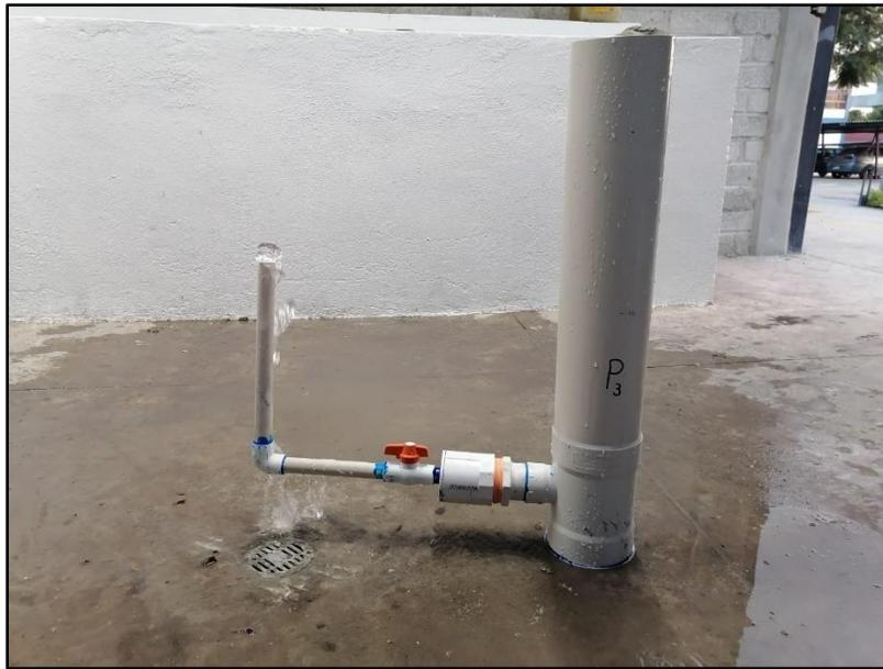
Figura 13.- Permeámetro de carga variable de elaboración propia.
