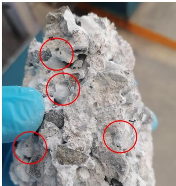
*Figura 51.-Eflorescencia en cilindro de concreto permeable ACR-Control.*
