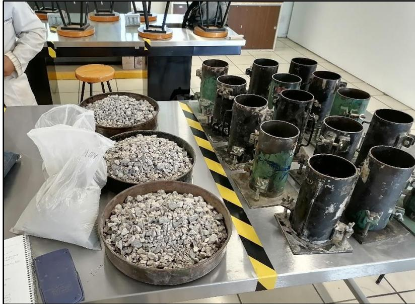
*Figura 7.-Material pesado según la dosificación de la mezcla, previo al colado de las probetas.*
