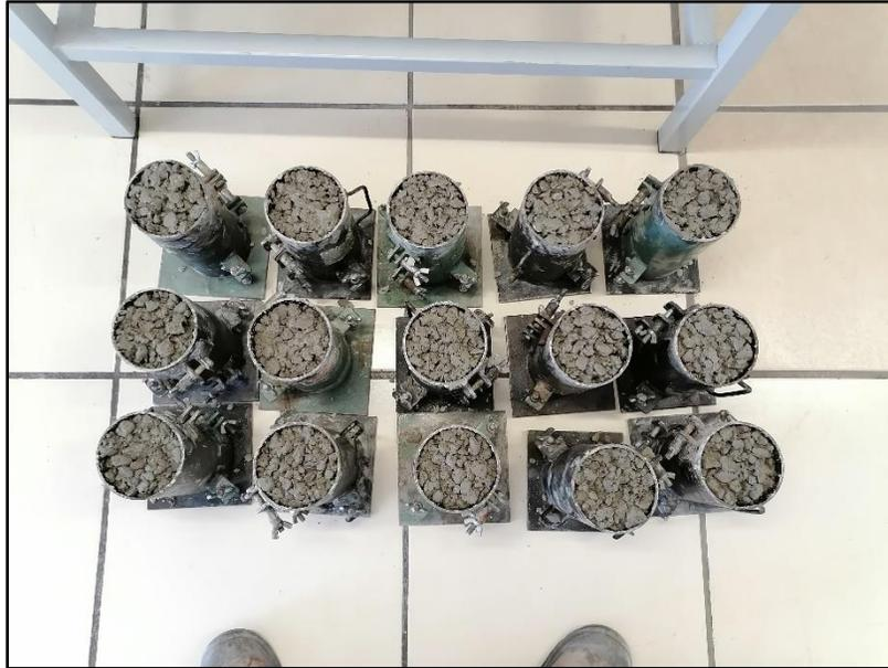
Figura 9.-Especímenes de concreto permeable con ACR recién colados.
