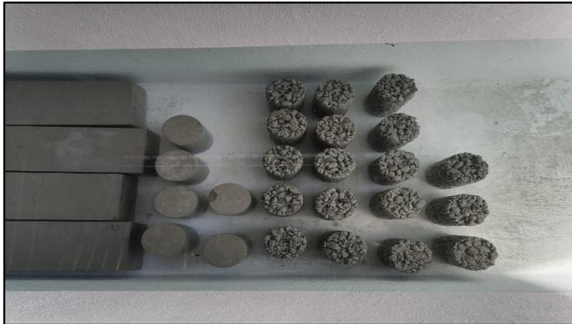
*Figura 10.-Curado de cilindros de concreto permeable en tanque de almacenamiento de agua.*
