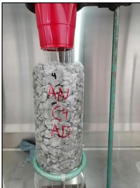
*Figura 23.-Filtrado de la solución en probetas de concreto permeable con AN.*
