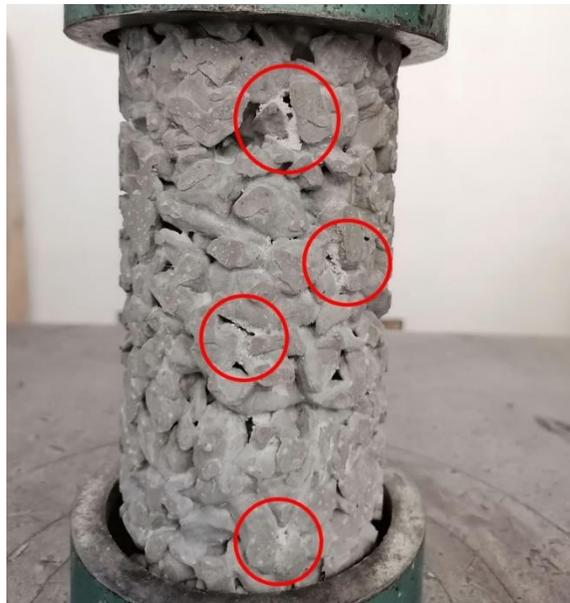
*Figura 50.-Eflorescencia en cilindro de concreto permeable AN-Control.*
