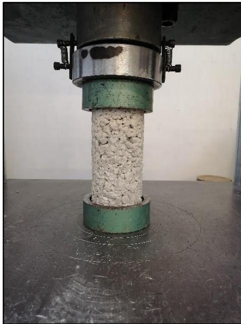
*Figura 24.- Montaje de cilindro de concreto permeable con ACR para prueba de compresión simple.*
