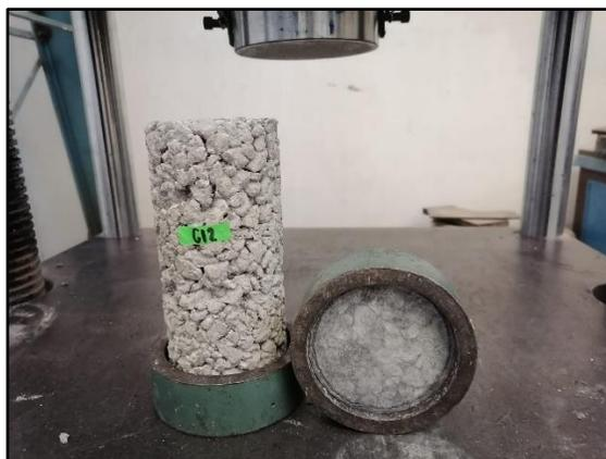
*Figura 25.- Cilindro de concreto permeable con casquetes de neopreno.*
