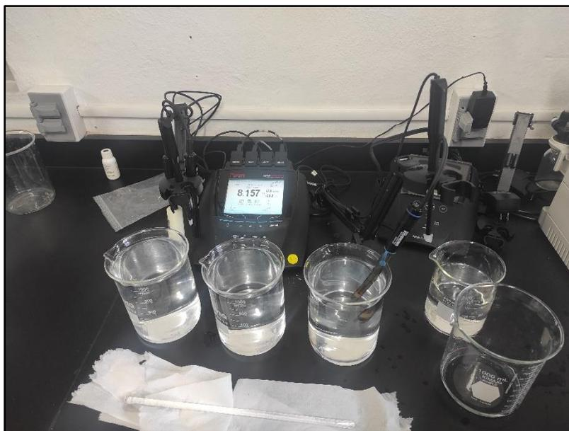
*Figura 20.-Medición del potencial de hidrogeno de la solución filtrada.*
