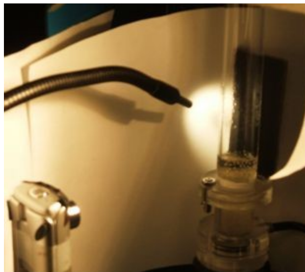
Figura A3.2. Columna de inyección de gas y esquema de adquisición de imágenes
