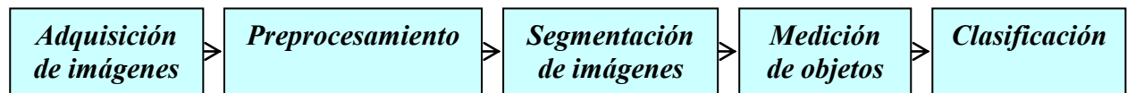
Figura 2.10. Configuración de un sistema de procesamiento de imágenes general que incluye los cinco componentes (Du y Sun, 2004)
